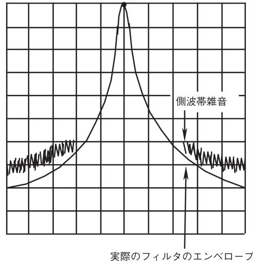
図6.2.3-1 単側波帯雑音のイメージ図
