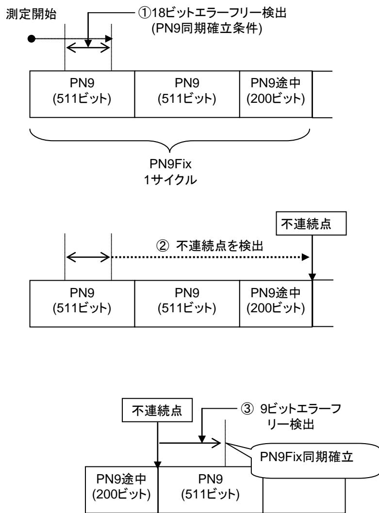
図8.8-4 PN9Fix パターンの同期確立動作例
