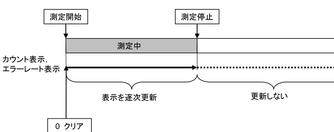
図8.5-9 Measure Mode Single および Endless
