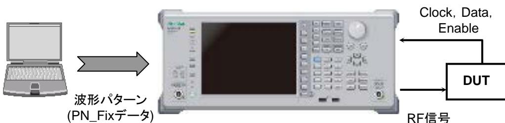
図8.8-6 PN\_Fix データを使用した BER 測定
