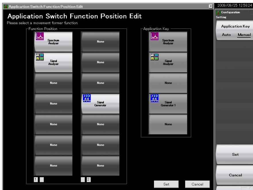
図 3.5.4-2 Application Switch Function Position Edit 画面
