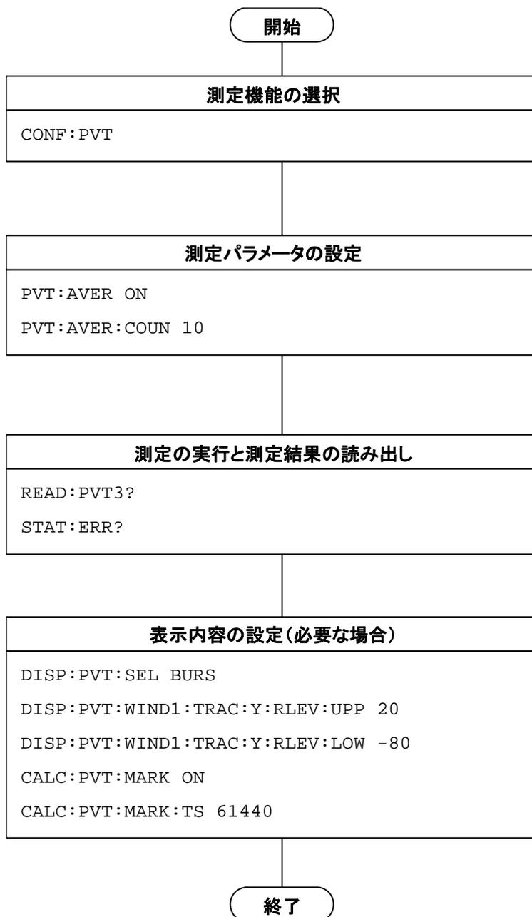
図1.2.5-1 Modulation 測定の流れとコマンド例
