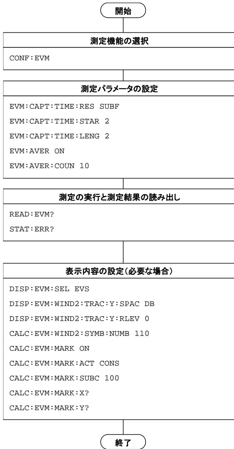
図1.2.4-1 Modulation 測定の流れとコマンド例
