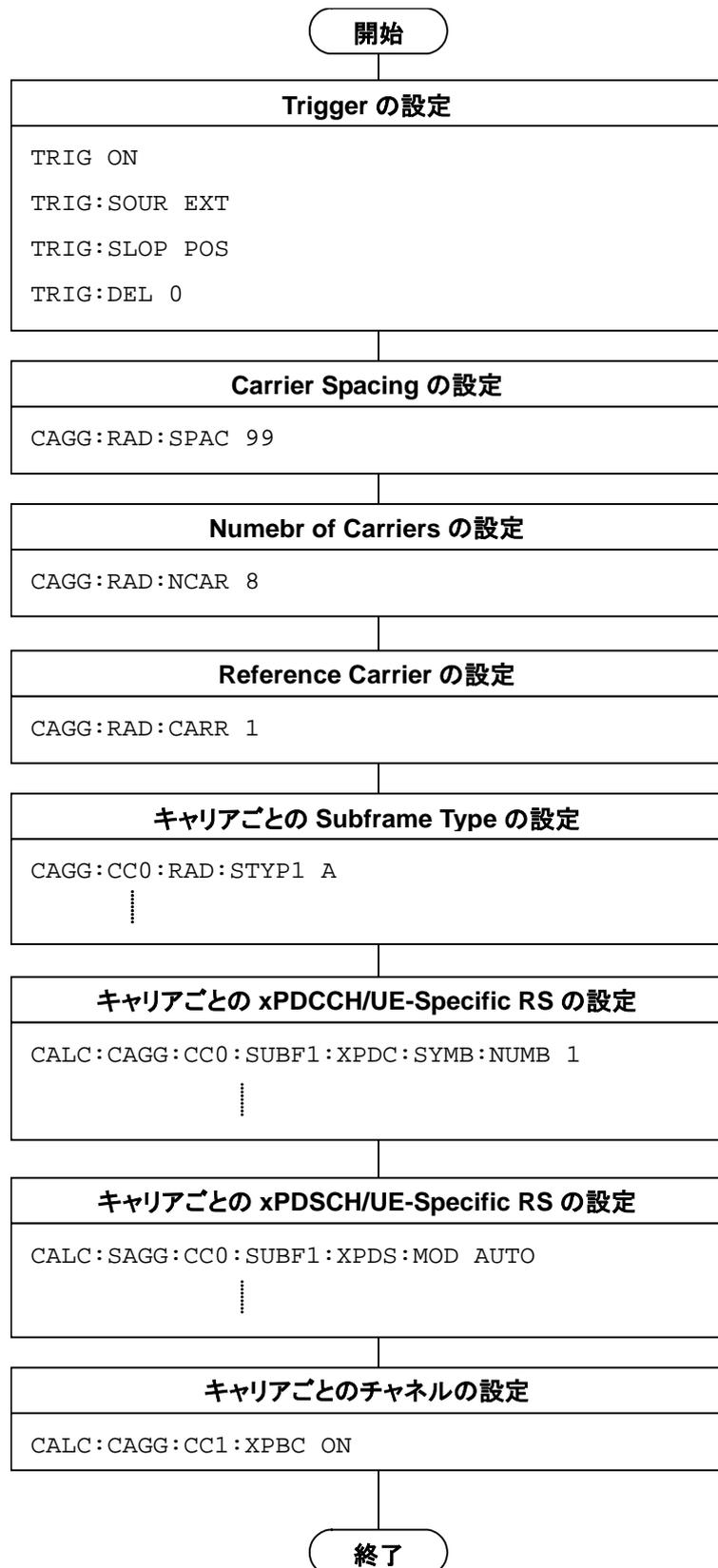
図 1.2.3-2 Modulation 共通の設定の流れとコマンド例
