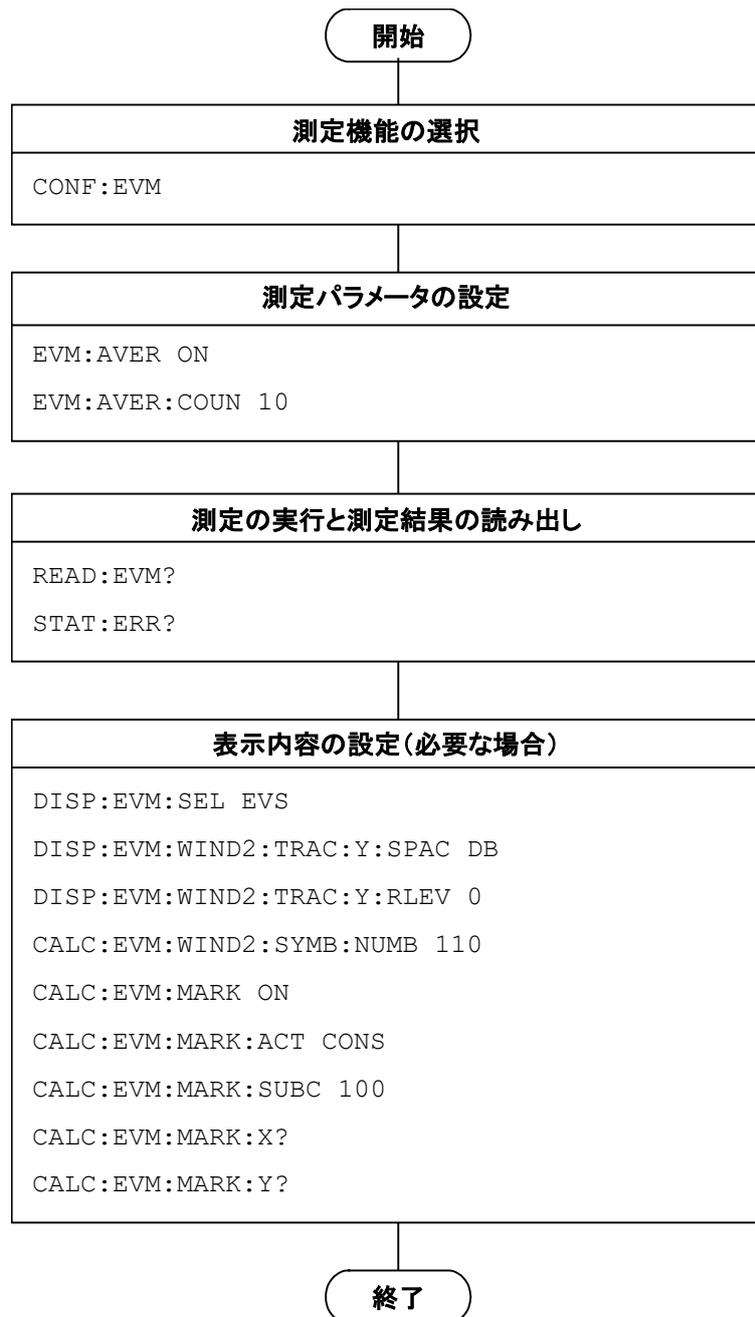
図 1.2.4-1 Modulation 測定の流れとコマンド例
