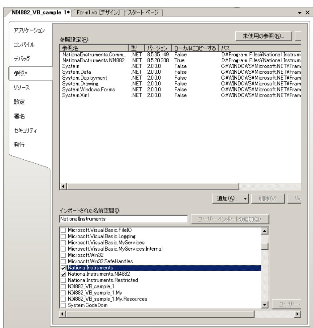
図D.1-3 プロジェクトの参照設定 (Visual BASIC のみ)
