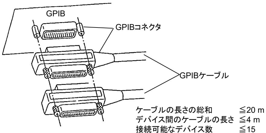
図 2.2.2-1 GPIB ケーブルの接続方法 1
