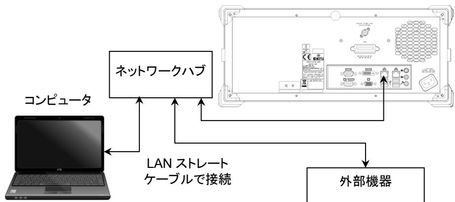
図 2.2.1-2 本器と複数の外部機器の接続例
