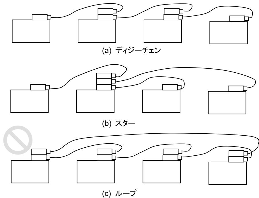
図 2.2.2-2 GPIB ケーブルの接続方法 2
