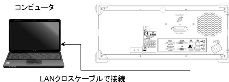
図 2.2.1-1 本器と 1 台の外部機器の接続例
