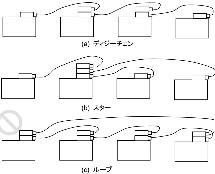
図 2.2.2-2 GPIB ケーブルの接続方法 2
