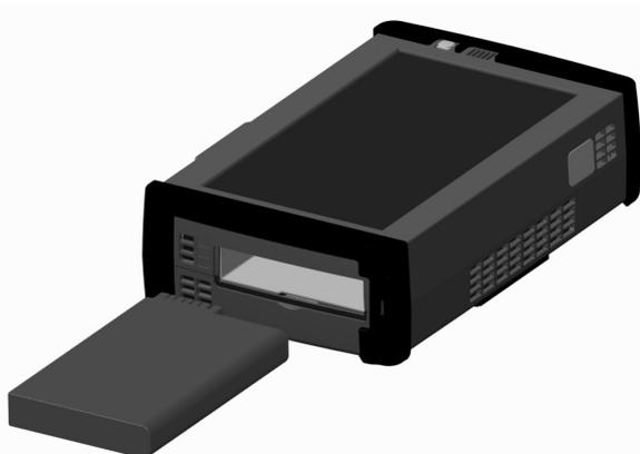
6. バッテリーを取り付けるときに、バッテリー端子の方向に注意してください。本器の前面を上にして、バッテリー収納部が正面を向くようにして置いたとき、端子は左上角にあります。
