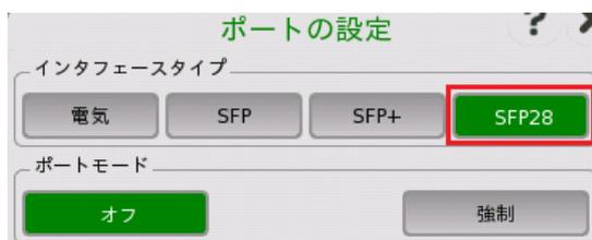
Portのクイックメニューで
