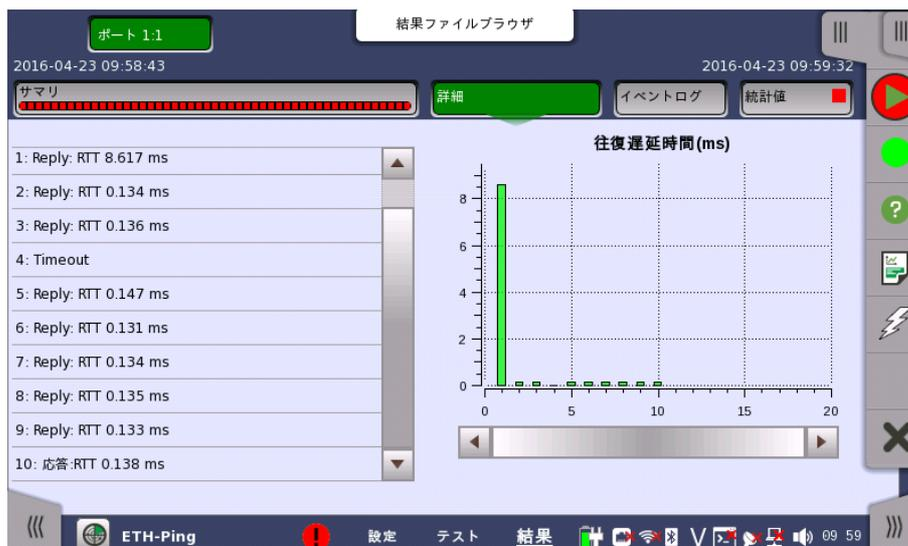
この画面には、イーサネットPingテストの結果の詳細が表示されます。結果は指定したポートのPingリクエストの往復遅延時間を表示します。データはリスト形式とグラフ表示の両方で表示されます。
