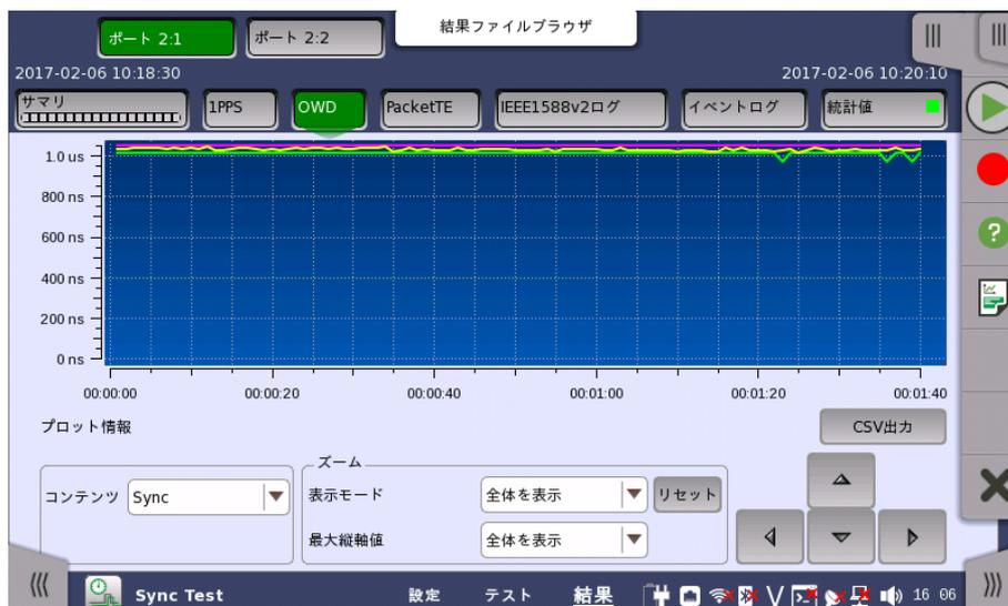
この画面には、片方向遅延テストの結果が、経時変化を示すグラフとして表示されます。
