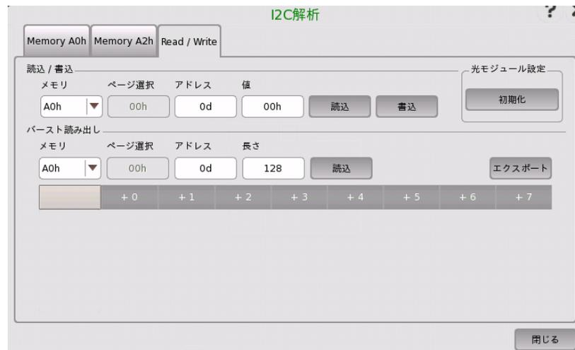
このダイアログボックスでは,インタフェースにI<sup>2</sup>C (Inter-Integrated Circuit) を使用して光トランシーバのレジスタを読み書きすることができます。
