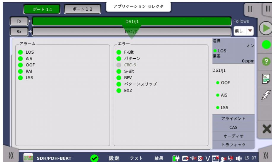
この画面には、DS1/J1 インタフェースに関連した詳細なアラームおよびエラー情報が表示されます。ステータスは、[カラーランプアイコン](#)で表示されます。
