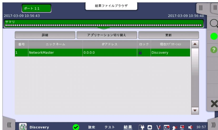
この画面には、ネットワークマスタを検索した結果が最大で16個表示されます。ネットワークマスタにパスワードが設定されている場合、[ロック] 欄にアイコンが表示されます。表をタッチして行を選択すると、次のボタンが操作できます。
