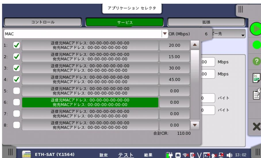
[有効] チェックボックスを使用して、[サービス] フィールドで指定されたサービスを有効/無効にします。
