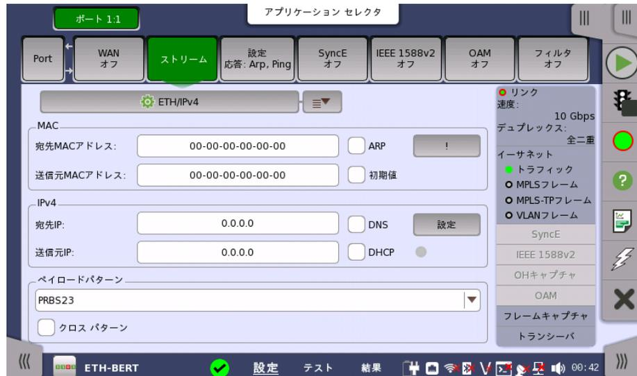
この画面では、ネットワークマスタによって送信されるイーサネット フレーム コンテンツを設定します。表示される内容は現在のレイヤの選択（イーサネット フレームを構成するさまざまなカプセル化とプロトコル ヘッダ）によって異なります。設定エリア左上のボタンをタッチすると、レイヤに関連した設定をするダイアログボックスが表示されます。
