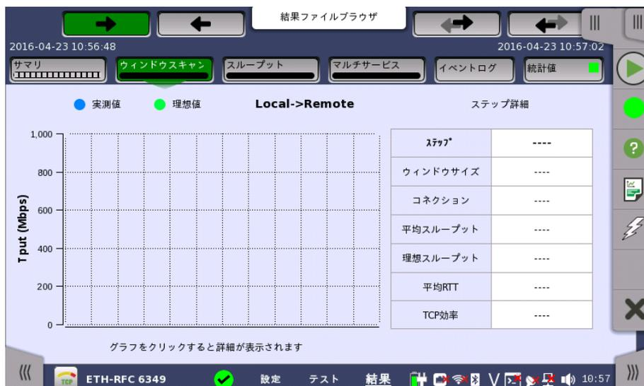
この画面はウィンドウスキャンの結果を表示します。スループットの理想値と実測値がグラフに表示されます。グラフのパーをタッチすると、右の表にそのステップの詳細が表示されます。
