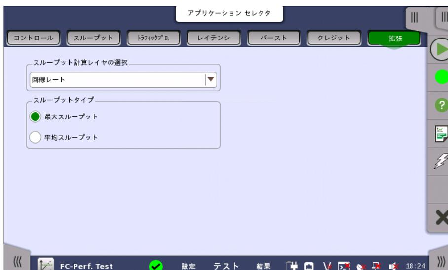
この画面の設定は、次のテスト結果のMeasured Throughputの測定方法を設定します。一度測定した後に拡張画面の設定を変更しても、測定結果の表示は変わりません。
