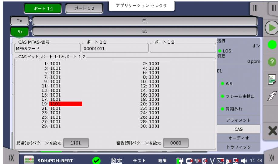
CAS (Channel Associated Signaling) 信号を使用できる場合、この画面にCAS信号に関する情報が表示されます。30チャンネルすべてに双方向の4つの信号ビットの状態が表示されます。アクティビティは太字で表示されます。
