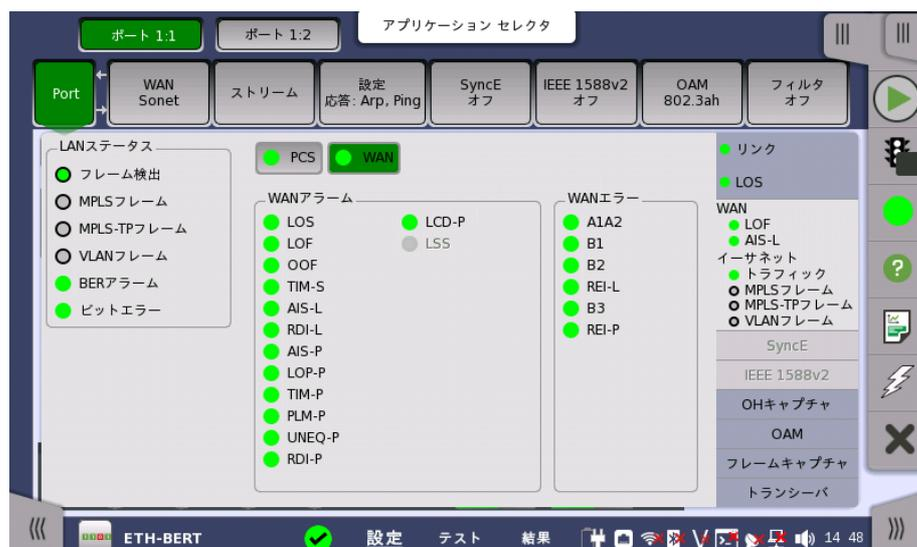
このダイアログには、現在のステータスを示すLEDアイコンの付いた主要なインタフェースステータス インジケータが表示されます。これらのインジケータは回線の状態の簡単な概要を表示します。
