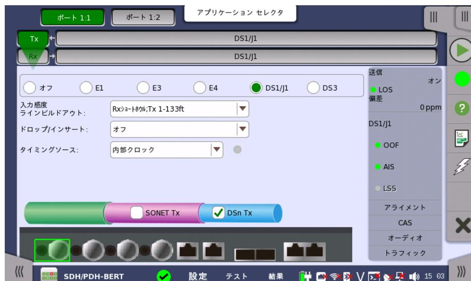
PDH TxとDSn Txを切り替える方法については、「E1の設定およびステータス」の[物理層設定](#)を参照してください。ラジオボタンの [オフ] をタッチすると、トランスミッタが無効になります。
