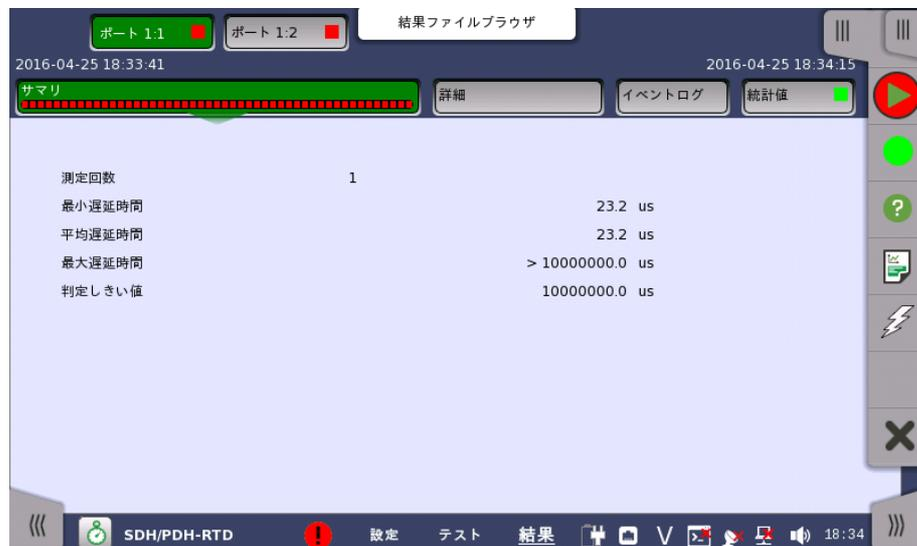
この画面には、測定対象となるポートの遅延時間測定結果のサマリが表示されます。ポートごとに以下の情報が表示されます。
