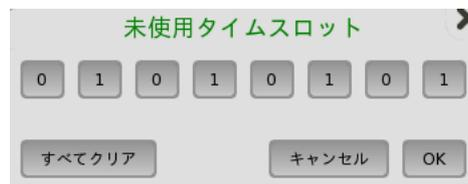
[未使用のタイムスロット] ダイアログボックスで、ビットキーをタッチして、個別のビットを変更します。これによりビット キーのバイナリ値がロジック 1 から 0 または 0 から 1 に切り替わります。[OK] をタッチして変更を決定し、ダイアログボックスを閉じます。
