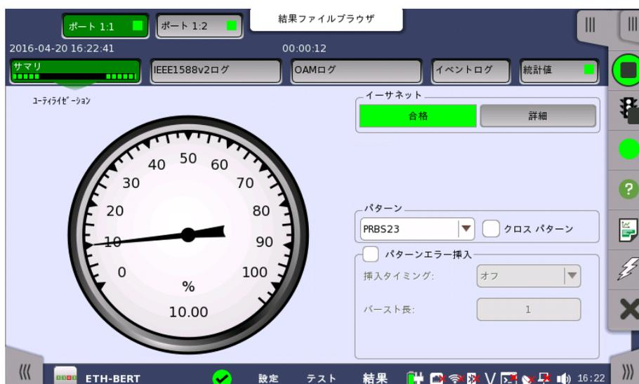
スループット情報を表示するには、ドロップダウンメニューで [スループット] を選択して、ダイヤルを拡大します。拡大したダイヤルの上のドロップダウンメニューを使用して、関連レイヤを選択します。
