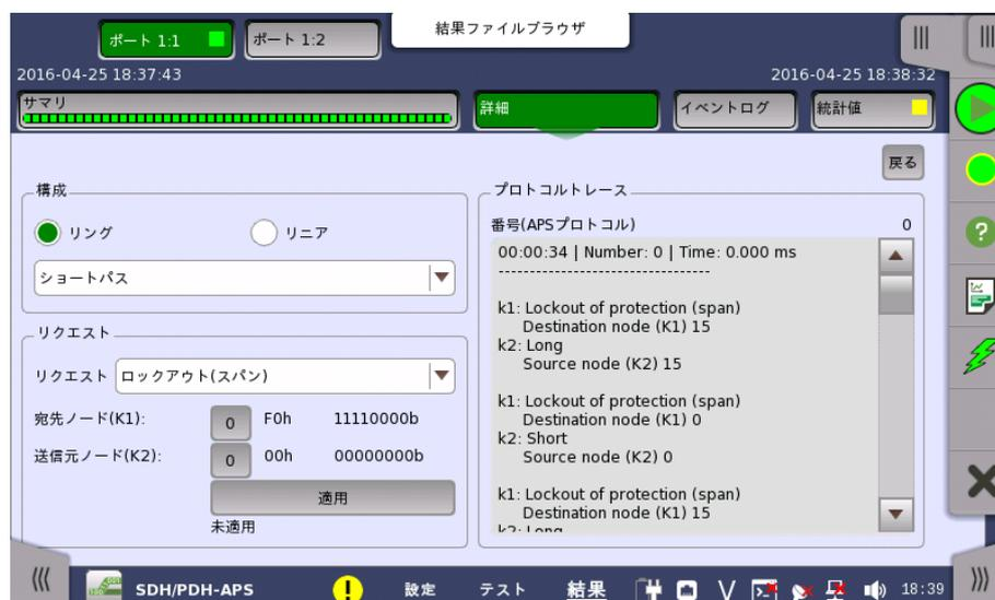
この画面には選択したポートのプロトコルの説明が表示されます(テスト中のK1とK2に関する詳細なデコード情報)。また、テストで使用されるリクエストを設定できるパラメータも含まれます。
