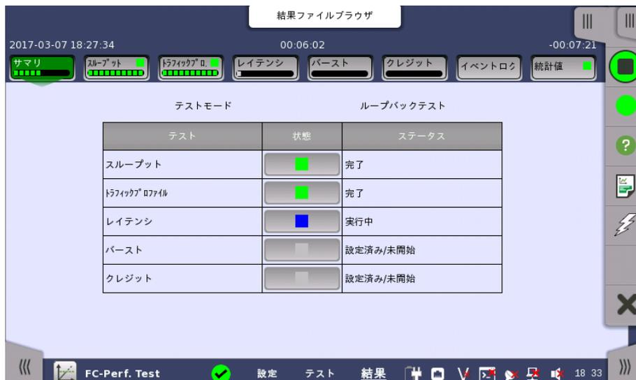
この画面には,テストの現在のステータス (「設定済み/未開始」,「実行中」,「完了」,または「未設定」) が表示されます。特定のテストのステータスボタンをタッチすると,そのテストの結果画面が表示されます。
