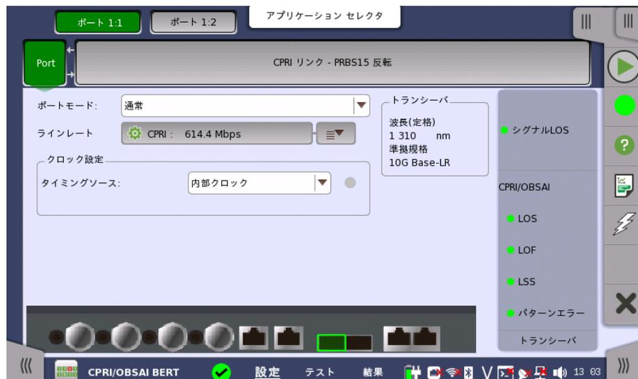
この画面で現在選択されている CPRI/OBSAI ポートの物理ポート設定を指定できます。また、選択したポートのステータスの検査にも使用できます。
