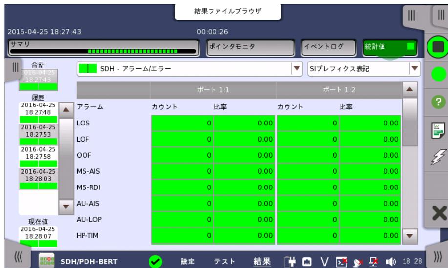
この画面はテスト結果の詳細な分析を示します。測定開始からの結果の合計を表示するか,テスト中の特定の区間の結果を表示するかを選択できます。特定の結果項目を拡大することもできます。結果は表(リスト)形式で表示するか,グラフ形式で表示できます。
