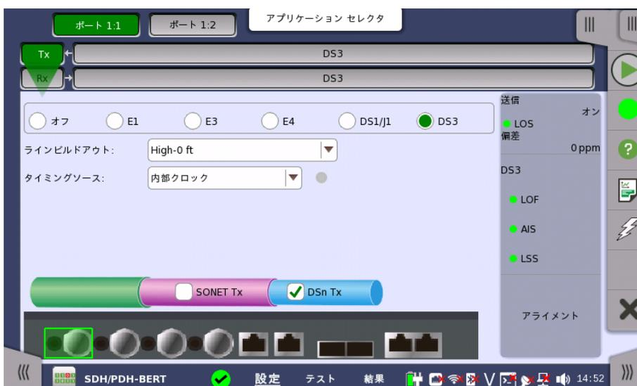
PDH TxとDSn Txを切り替える方法については、「E1の設定およびステータス」の[物理層設定](#)を参照してください。[DS3] ラジオボタンをタッチします。ラジオボタンの [オフ] をタッチすると、トランスミッタが無効になります。
