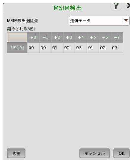
このダイアログボックスでは、MSIM (Multiplex Structure Identifier Mismatch) の検出方法を設定します。
