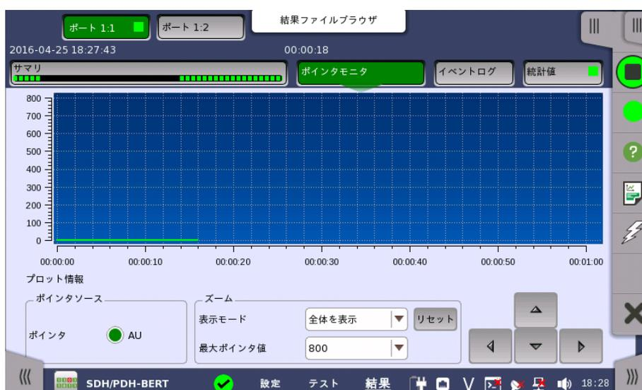
この画面には、モニタされた信号のポインタ値の変化が表示されます。結果は、ポインタ値の経時変化を示すグラフとして表示されます。
