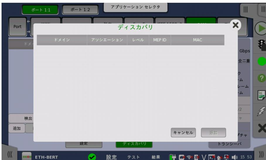
デバイスが検出されたら、ダイアログリストに表示されます。リストからデバイスを選択し、ダイアログボックスの [追加] ボタンをタッチします。選択したデバイスがリストに追加され、ディスカバリ画面に表示されます。
