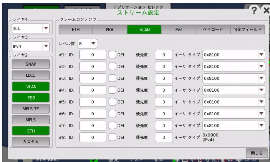
VLAN (Virtual LAN) は物理ネットワーク内に独立した論理ネットワークを作成するために使用します。有効になっている場合、16ビットのIEEE 802.1Qフィールドと16ビットのイーサタイプフィールドがヘッダーに追加されます。802.1Qは3つの部分に分かれています。
