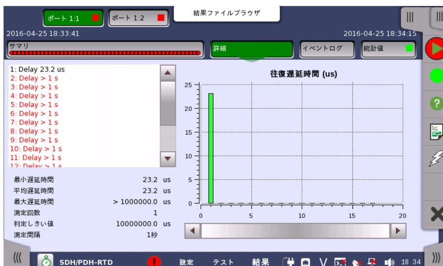
ポートを選択するためのボタンが画面上部に表示され、テストの合格/不合格ステータスがカラーで表示されます。
