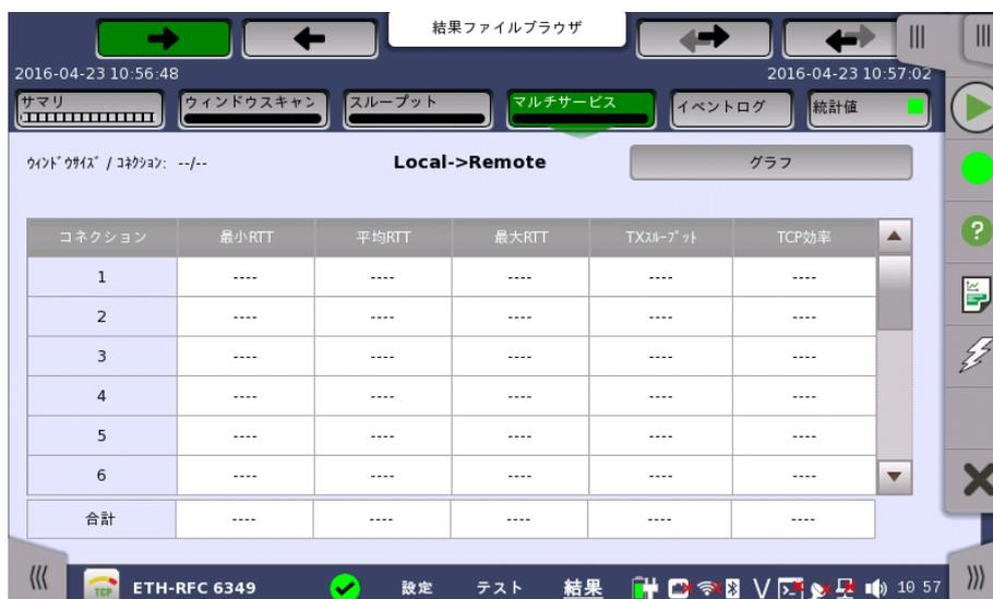
この画面には、TCPコネクション別にRTT、スループット、および [TCP 効率](#)が表示されます。[グラフ形式] ボタンと [表形式] ボタンを使用して、結果の表形式とグラフィック表示を切り替えます。
