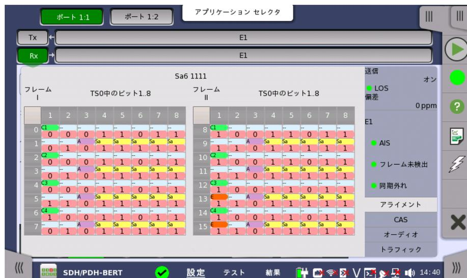
フレームのアライメントが使用できる場合、このダイアログにフレームのアライメントに関する情報が表示されます。フレームのアライメント情報には、CRC4 マルチフレームの FAS/NFAS の先頭16ワードが含まれます。
