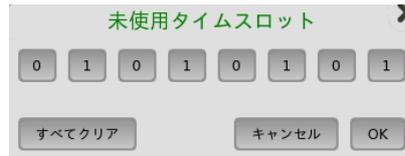
[未使用タイムスロット] ダイアログボックスで、関連ビットキーをタッチして、個別のビットを変更します。これによりビットキーのバイナリ値がロジック 1 から 0 または 0 から 1 に切り替わります。[OK] をタッチして変更を決定し、ダイアログボックスを閉じます。
