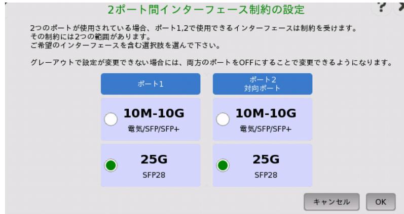
2ポート間インターフェース制約の設定ダイアログボックスでは, eCPRI/RoE BERTアプリケーションで設定できるビットレートを選択します。
