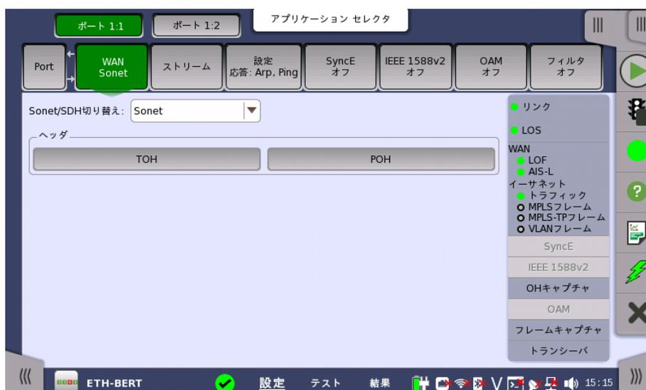
この画面で現在選択されているイーサネット ポートのWANインタフェース サブレイヤの設定を指定できます。また、選択したポートの現在のステータスの検査にも使用できます。
