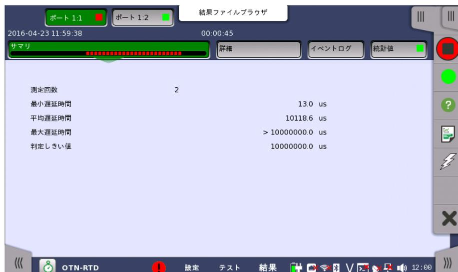
この画面には、テスト対象となるすべてのポートの RTD テスト結果のサマリが表示されます。ポートごとに以下の情報が表示されます。
