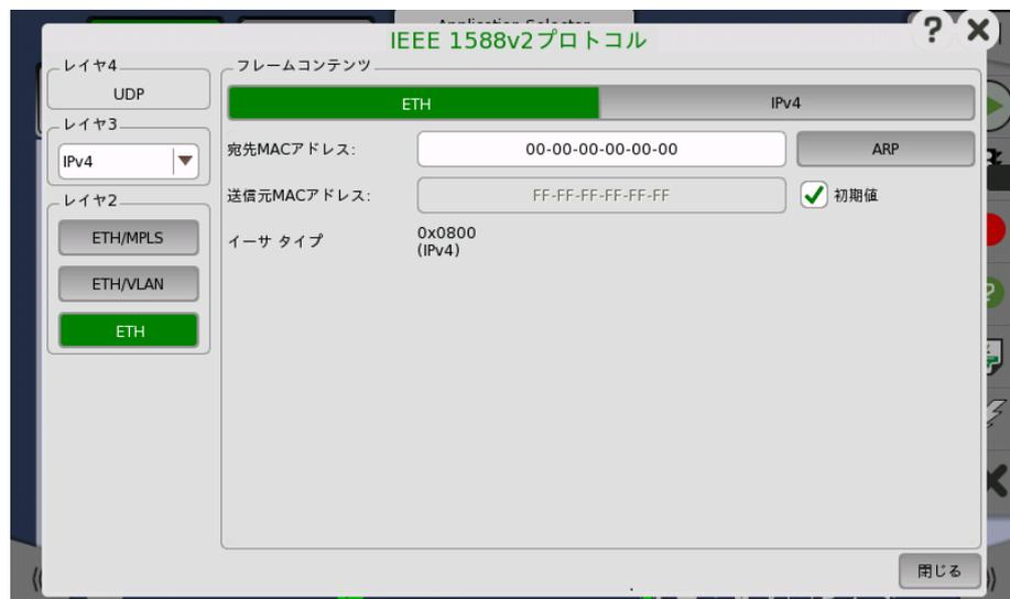
[IEEE 1588v2プロトコル] ダイアログボックスの左側のボタンで関連するレイヤを選択します。現在の選択内容は、[フレームコンテンツ] エリアの上部に表示されます。[フレームコンテンツ] エリアでレイヤ ボタンのどれかをタッチすると、そのレイヤの設定パラメータが表示されます。
