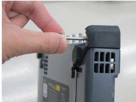
4. MU100090Aに10Gマルチレート モジュールを取り付けます。以下が組み合わせるように10Gマルチレート モジュールをMU100090Aの上に置きます。7- 10, 8- 11, 9- 12
