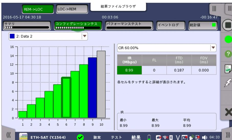
この画面は特定のサービスのコンフィグレーションテスト結果の詳細を表示します。画面上部にあるドロップダウンメニューを使用して、表示するサービスを選択します。
