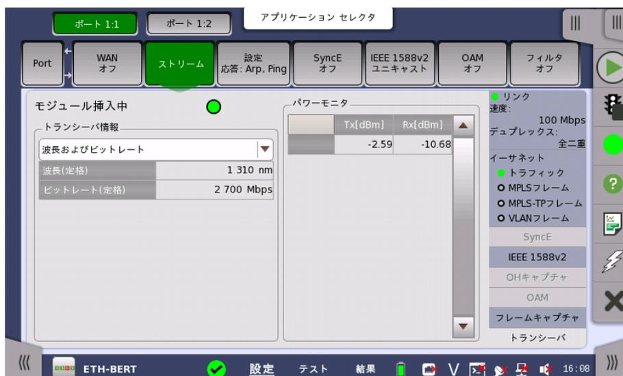
このダイアログは、光トランシーバ (コネクタパネルに装着されているプラグインモジュール) の状態に関する情報を表示します。
