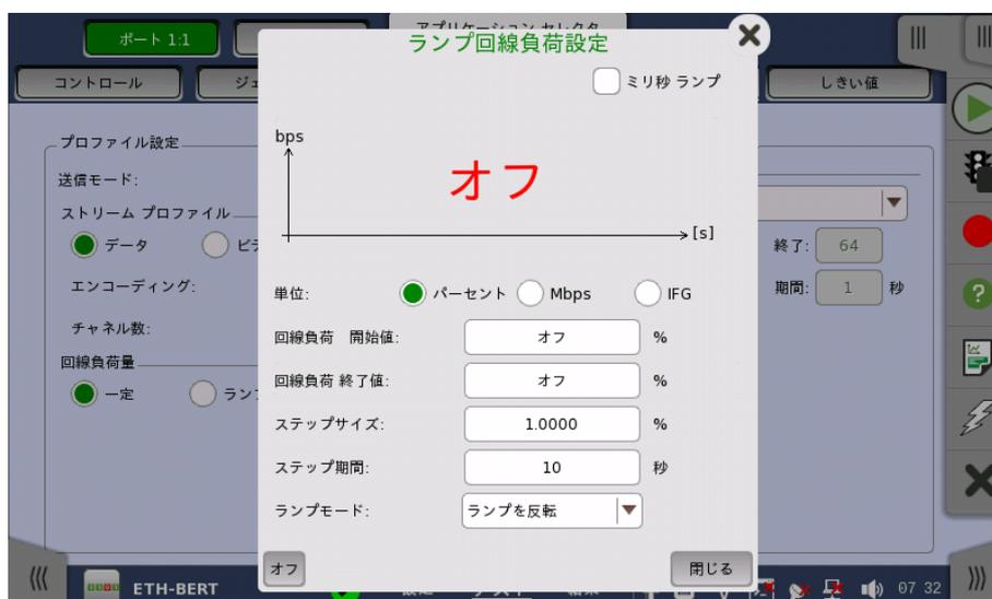
回線負荷量の単位は[パーセント], [Mbps], または [IFG] を指定できます。単位がIFG (フレーム間ギャップ) の場合、12 バイトが100パーセントの回線負荷量になります。また、フィールドに設定する値は、フレーム間ギャップ長の平均値です。
