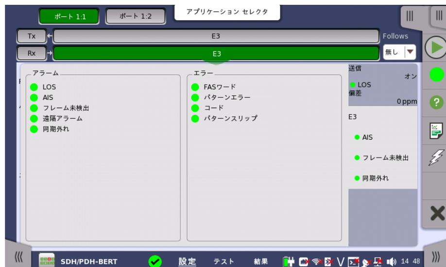
このダイアログには、E3インターフェースに関連した詳細なアラームおよびエラー情報が表示されます。ステータスは、[カラーランプアイコン](#)で表示されます。
