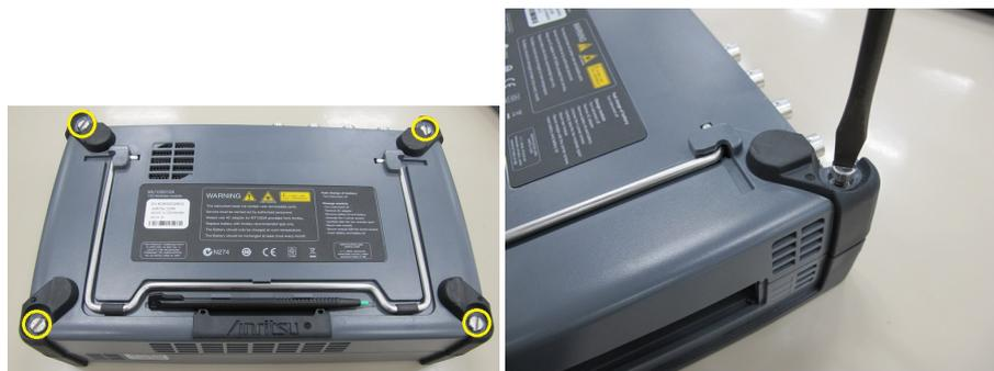
5. すべてのネジを緩めたら、10Gマルチレート モジュールの両側を持ち上げて取り外します。取り外せない場合は4隅のネジを再度緩めてください。取り外すと、以下のようになります。
