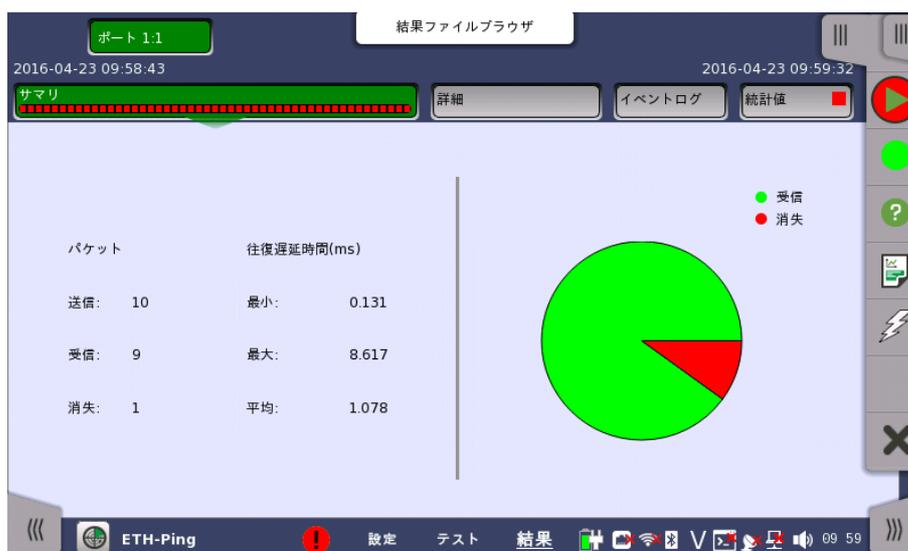
この画面には、イーサネットPingテストの結果のサマリが表示されます。結果は、指定されたポートの送信/受信/消失パケットおよび最小/最大/平均往復遅延時間を表示します。
