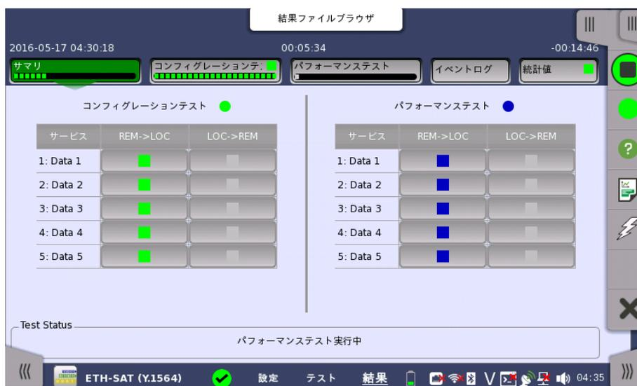
この画面は、サービスアクティベーション テスト結果のサマリを表しています。特定のサービスの [コンフィグレーションテスト],または [パフォーマンステスト] ボタンをタッチして、結果情報の詳細に関する画面を表示させます。
