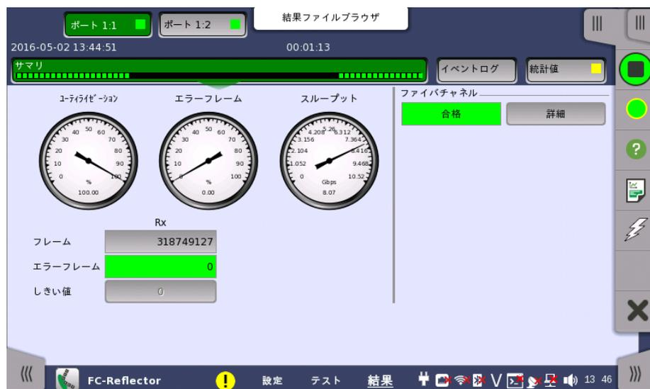
この画面には、FC Reflectorテストの結果のサマリが表示されます。この情報には、エラーフレーム数およびしきい値を超えた項目数が表示されます。
