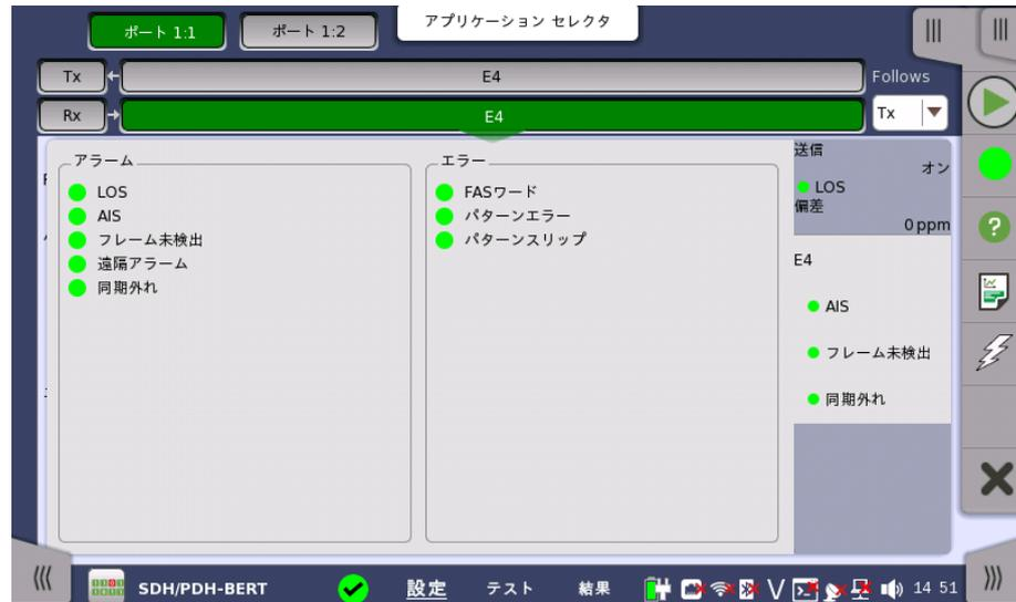
この画面には、E4インターフェースに関連した詳細なアラームおよびエラー情報が表示されます。ステータスは、[カラーランプアイコン](#)で表示されます。
