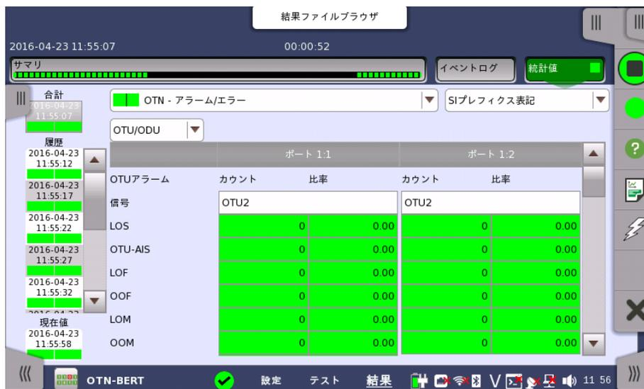
この画面はテスト結果の詳細な分析を示します。現在の結果(1秒間に測定された結果) または測定開始からの合計結果のいずれかの表示を選択できます。特定の結果項目を拡大することもできます。結果は表(リスト)形式で表示するか、グラフ形式で表示することができます。
