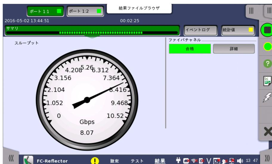
[テスト設定] 画面の「しきい値」にて [ファイバチャネル] チェックボックスを選択している場合、右上隅の [ファイバチャネル] 情報には、合格/不合格が表示されます。[詳細] ボタンをタッチして、個別の合格/不合格を検査できます。
