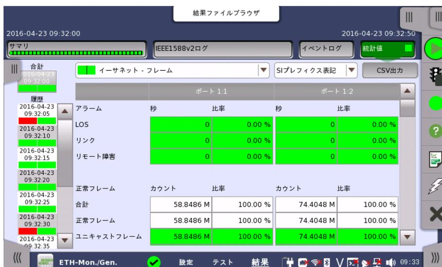
この画面はテスト結果の詳細な分析を表示します。測定開始からの結果の合計を表示するか、テスト中の指定したインターバルの結果を表示するかを選択できます。指定した結果の項目を拡大することもできます。結果は表(リスト)形式で表示するか、グラフ形式で表示できます。
