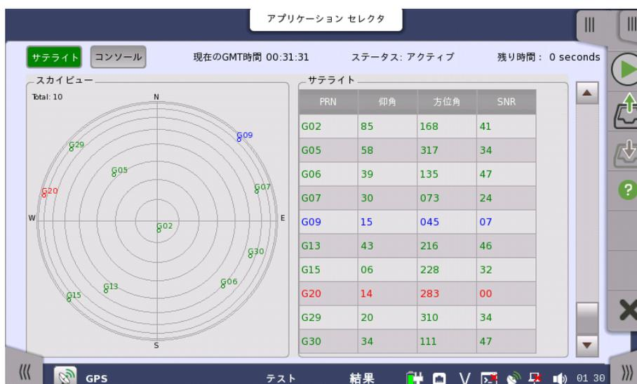
この画面では衛星の位置とログデータが表示されます。左上のボタンをタッチして結果表示を切り替えます。
