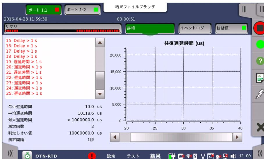
ポートを選択するためのボタンが画面上部に表示され、テストの合格/不合格ステータスが色で表示されます。
