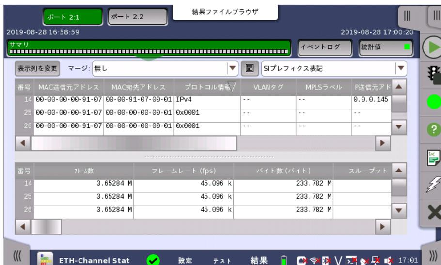
この画面には、Channel Statisticsテストの結果のサマリが表示されます。画面には2つのリストがあり、1つはチャンネルの設定で、もう1つは各チャンネルの結果を表示します。どのチャンネルも2つのリストに行として表示されます。
