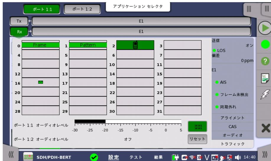
この画面には、2 Mbps回線に表示される音声チャンネルのアクティビティが表示されます。トラフィック表示とタイムスロットコンテンツの表示に切り替えることができます。
