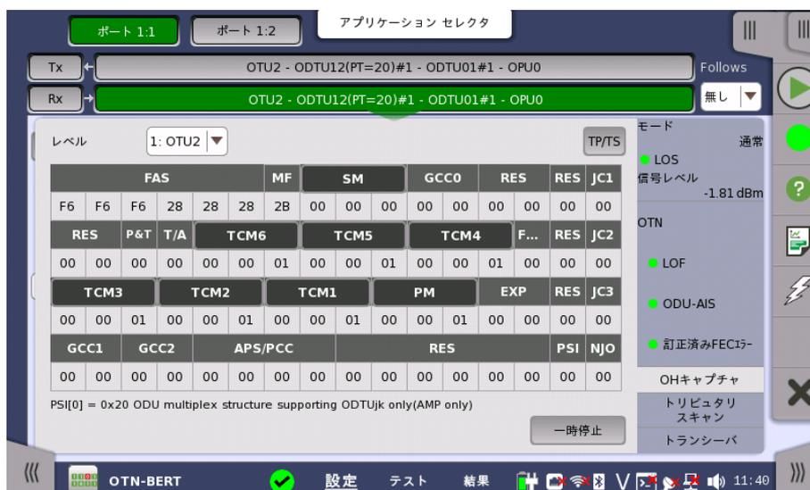
このダイアログボックスには、一度に1フレームずつOTU/ODU/OPU OHキャプチャのステータス情報が表示されます。[レベル] ドロップダウン メニューを使用して、表示する多重レベルを選択します。フレーム構造の説明については、[オーバーヘッド ダイアログボックス](#)の項を参照してください。
