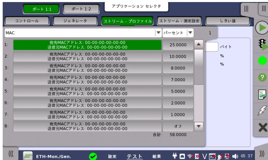
スライドアウト リストの上部で表示する内容をMAC,IP, およびVLAN情報に切り替えることができます。
