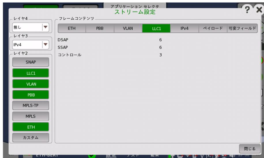
[DSAP],[SSAP] および [コントロール] フィールドは、上位プロトコルレイヤに基づいて自動的に設定されます。
