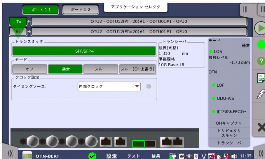
この画面で、OTNトランスミッタの光インタフェースを有効にすることができます。また、ナビゲーションエリアのボタンで選択したポートの現在のステータスの検査にも使用できます。
