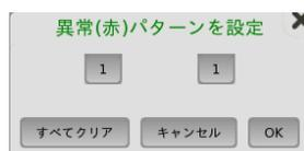
ESF/J1フレームでは、色のパターンは4つの2進数で構成されます。SF/D4フレームでは、色のパターンは2つの2進数で構成されます。最小許容値と最大許容値は、それぞれ00/0000と11/1111です。各桁のボタンをタッチして値を設定し、[OK] をタッチします。すべての値を消去して、値を設定し直すためには、[すべてクリア] ボタンをタッチします。
