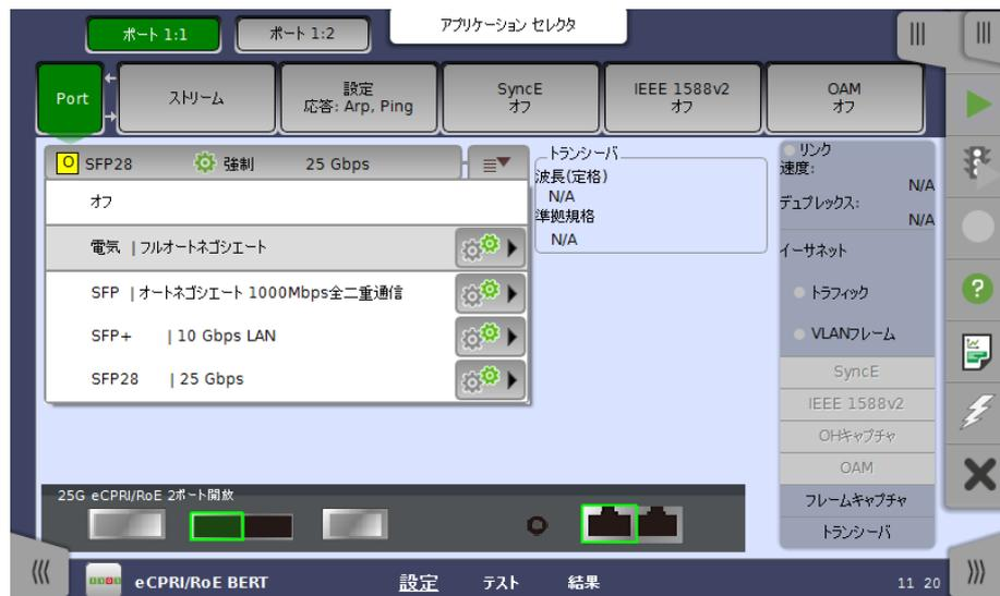
クイック設定メニューには、多数の事前定義のポート設定 ([電気 | 強制 100Mbps全二重] など)が含まれます。「詳細モード」([ポートの設定]ダイアログボックス)では個別の設定ができます。
