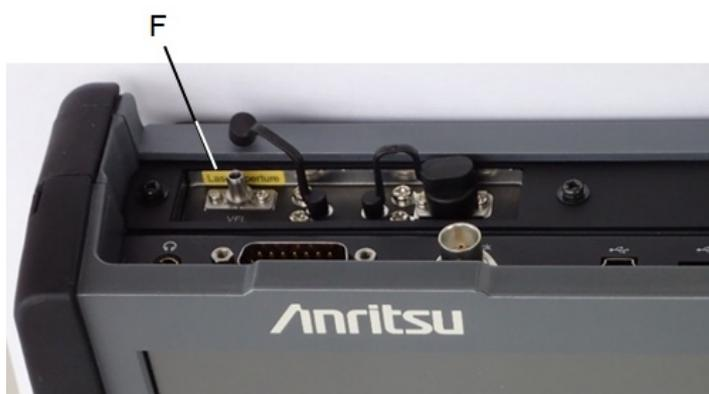
図8 ラベルの貼付位置 (オプション002付きの MU100020A, MU100021A, MU100022A)
