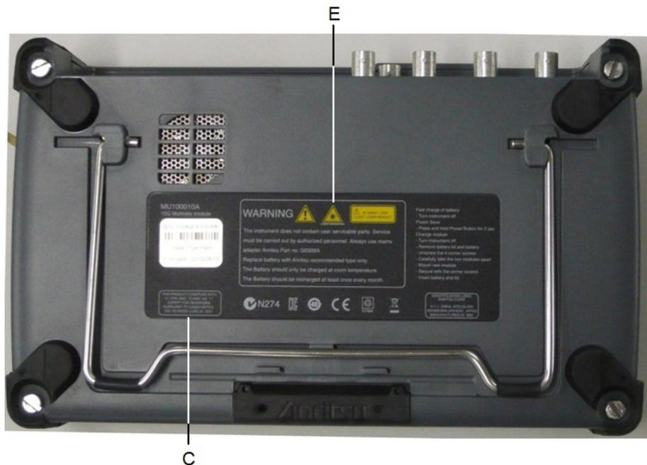
図5 ラベルの貼付位置 (MU100010Aと組み合わせたときの MU100020A, MU100021A, MU100022A)
