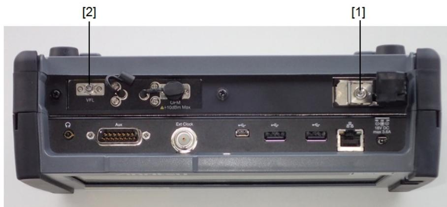
図1 レーザ光の開口位置 (MU100020A)
