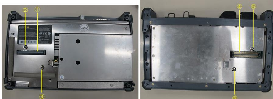
3. B0728A 背面パネルキットの1Uネジを背面パネルの4隅に挿入します。
