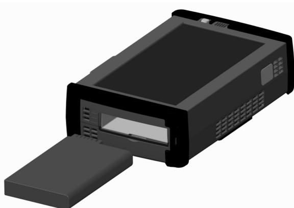
6. バッテリーを取り付けるときに、バッテリー端子の方向に注意してください。本器の前面を上にして、バッテリーコンパートメントが正面を向くようにして置いたとき、端子は左上角にあります。
