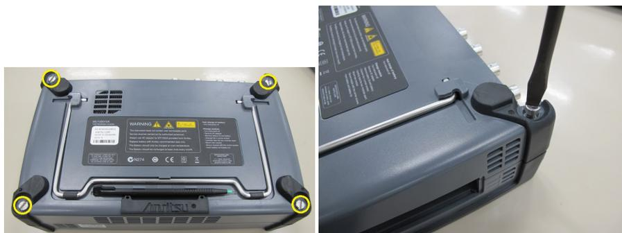
5. すべてのネジを緩めたら、10Gマルチレート モジュールの両側を持ち上げて取り外します。取り外せない場合は4隅のネジを再度緩めてください。取り外すと、以下ようになります。
