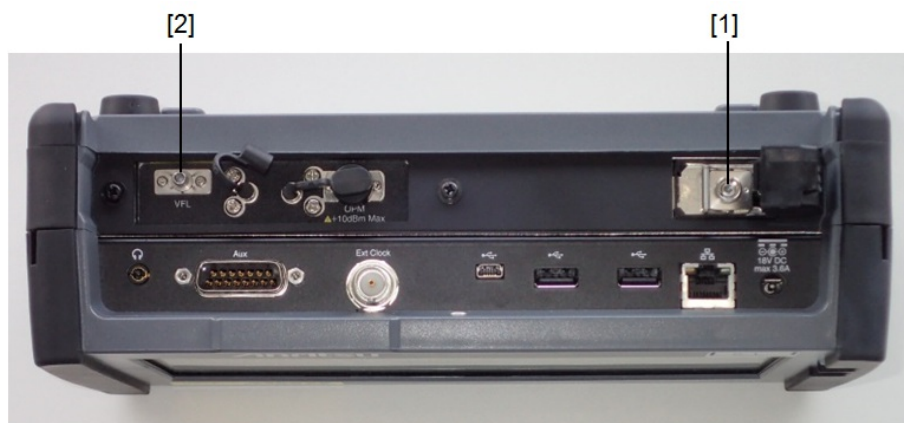
図1 レーザ光の開口位置 (MU100020A)
