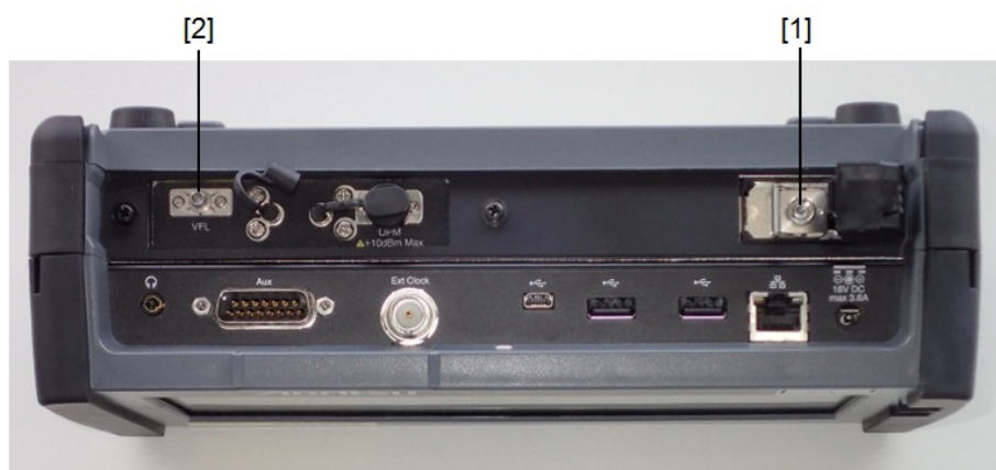
図3 レーザ光の開口位置 (MU100022A)
