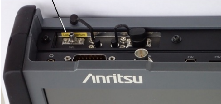
図8 ラベルの貼付位置 (オプション002付きの MU100020A, MU100021A, MU100022A, MU100023A)
