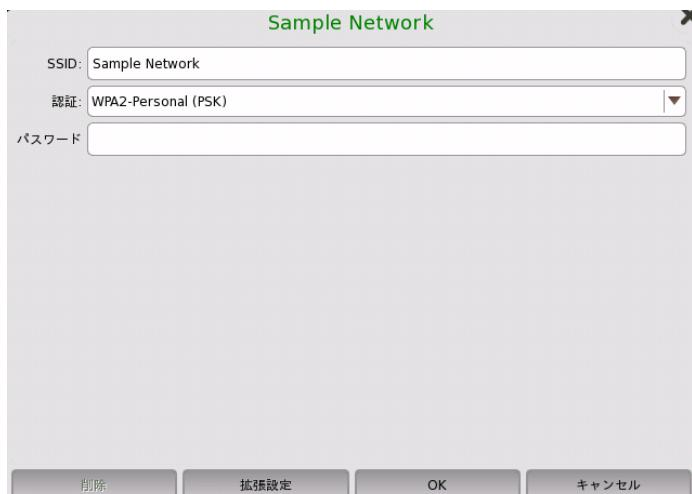
SSID名に\ (バックスラッシュ) と" (ダブルクオーテーション) を使用した場合、ネットワークに接続するとそれれ\\,\\"と [WLANの設定] ダイアログボックスに表示されます。
