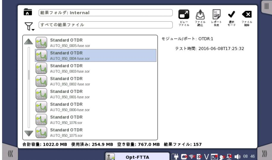
前のテストのワークスペースを作成すると、GUIでテスト結果を表示できます。[ビューファイル]/[ファイル読込] ボタンを押すと、直接テスト結果画面に移動しますが、そこからワークスペース内の他の画面にナビゲーションできます。
