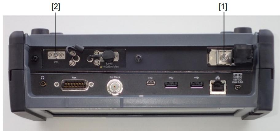
図3 レーザ光の開口位置 (MU100022A)
