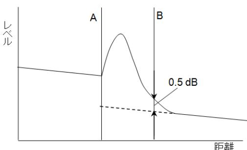
後方散乱光デッドゾーンを測定するカーソルの位置
