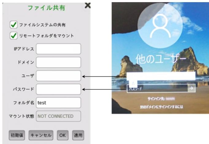
15. [適用] をタッチします。フォルダがマウントされると,CONNECTEDが表示されます。[OK] をタッチしてダイアログボックスを閉じます。
