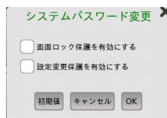
パスワードを変更/設定するには、1つ以上のチェックボックスをオンにして、[OK] をタッチすると、テンキーが表示されます。
