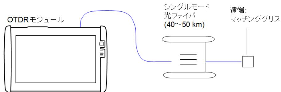
850 nmのリニアリティを試験する場合は、接続図の光ファイバをマルチモードファイバ(20 ~25 km)に変更してください。
