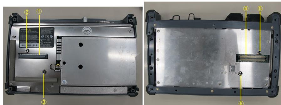
3. 10Gマルチレート モジュールの4隅のネジを抜き取り,B0728A 背面パネルキットの2Uネジに交換します。
