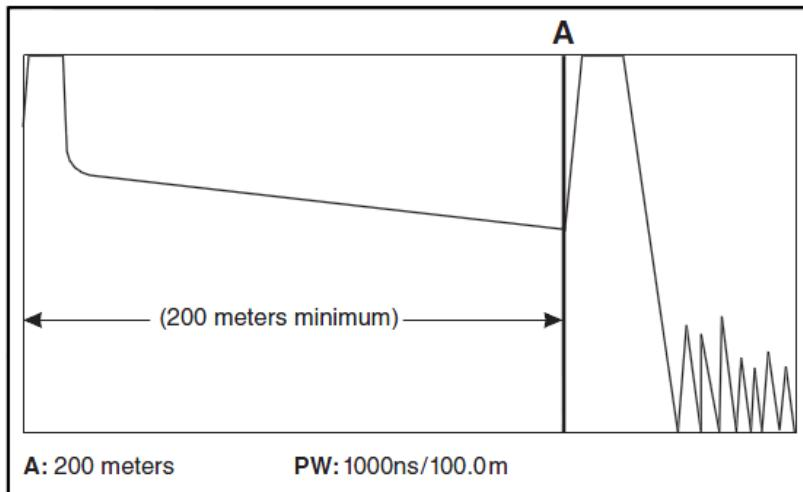
8. カーソルAを反射の立ち上がりにできる限り近づけるために,波形を拡大表示します。カーソルAは後方散乱の直線部分に置いてください。反射の立ち上がり部には置かないでください(手順7の  $1 \mu\text{s}$ パルス幅で口元からカーソルAが200 m 離れている図を参照)。カーソルAは,口元または波形の開始位置からパルス幅2つ分以内の位置に置いてもかまいません。
