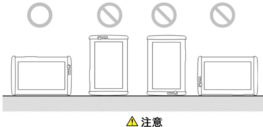
設置する向きが上図の○印でない場合、わずかな衝撃でバランスを崩して倒れ、負傷するおそれがあります。
