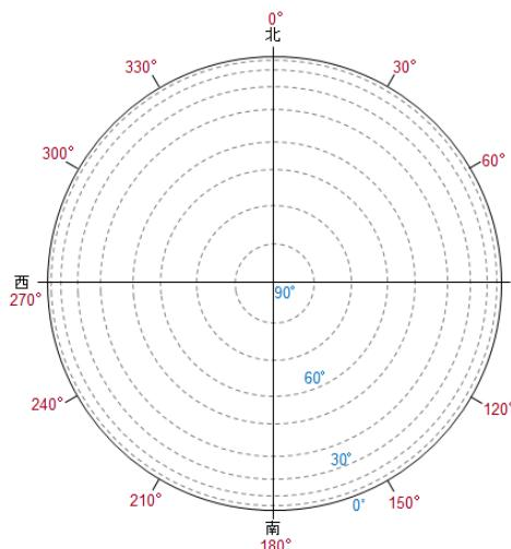
半径は仰角に対応します。円周の位置が仰角 0 度に対応します。時計方向の角度は水平角を表します。円の上が北に相当します。
