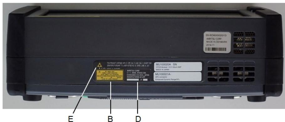
図6 ラベルの貼付位置 (MU100020A, MU100021A, MU100022A, MU100023Aの
