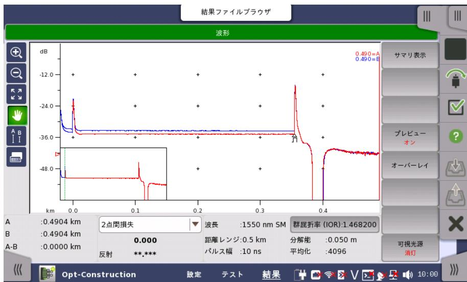
波形画面では、距離対ファイバ損失がグラフで表示されます。グラフには次のアイコンが表示されます。
