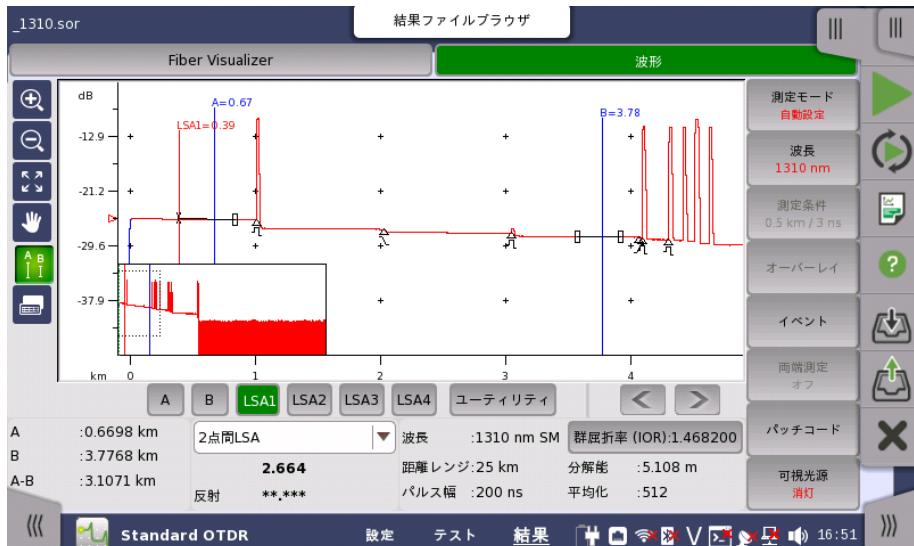
2点間 LSAは2点間で計算されるdB差 (Y軸) です。カーソルAのデータ (Y軸) がカーソルBのデータ (Y軸) より大きいと、損失は正の値になります。
