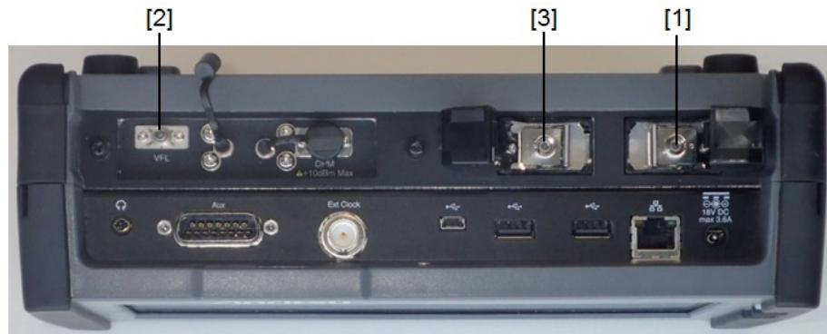
図2 レーザ光の開口位置 (MU100021A, MU100023A)
