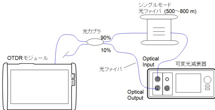
850 nm, 1300 nmのデッドゾーンを試験する場合は、接続図の光ファイバと光カプラをマルチモード光ファイバに変更してください。また、マルチモード光ファイバ用の光可変光減衰器を使用してください。
