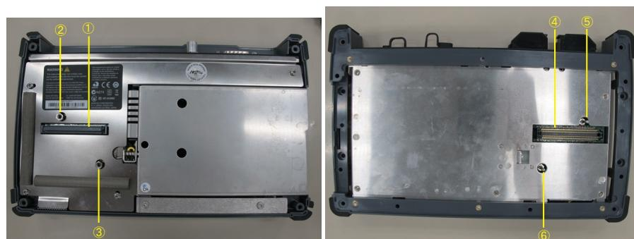
3. B0728A 背面パネルキットの1Uネジを背面パネルの4隅に挿入します。
