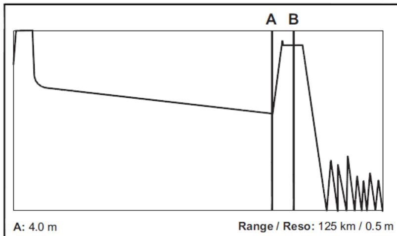
8. カーソルAを反射の立ち上がりにできる限り近づけるために,波形を拡大表示します。カーソルAは後方散乱の直線部分に置いてください。反射の立ち上がり部には置かないでください(手順7の図を参照)。
