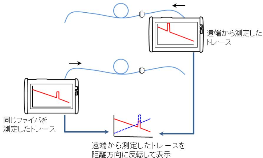
両端測定を [オン] にすると両方の波形から次の値が計算され、イベント解析結果に反映します。
