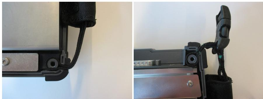
7. ハンドルおよび、キャリングストラップの連結部を保護しているキャップを取り外します。
