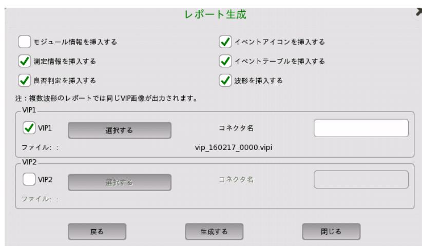
OLTS アプリケーションでは、[モジュール情報を挿入する] と [測定情報を挿入する] のチェックボックスだけが表示されます。
