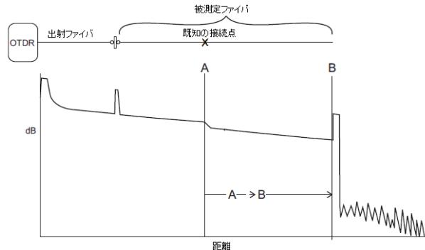
5. 正確にカーソルを配置するため, をタッチしてカーソルB付近を拡大表示します。
