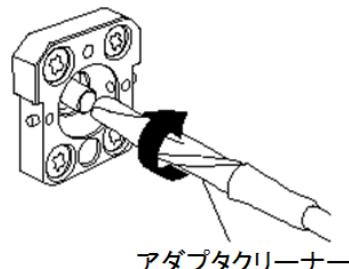
3. 新しいアダプタクリーナの先端部をフェルール端面に押し当て、一方向に2~3回拭き、仕上げます。
