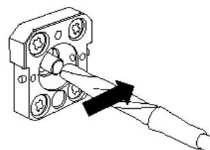
4. アダプタクリーナで交換可能光コネクタの内部を清掃します(下記光アダプタのクリーニング参照)。
