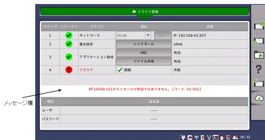
別売のMX109020A Site Over Remote Access Basic Licenseを利用すると、アンリツが提供するサーバを経由して、PCからネットワークマスタをリモート制御することができます。この画面では、ネットワークマスタをリモート制御するための設定をします。
