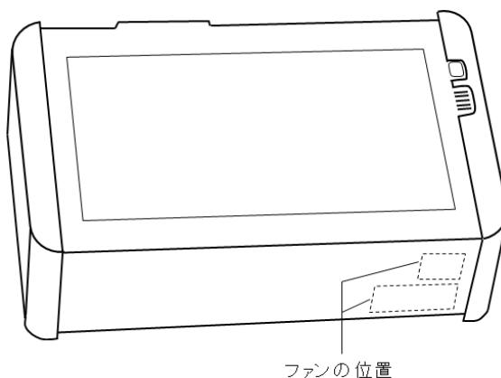
本器は側面から冷却用の空気を吸入して、底面に排気します。本器を机上で使用する場合は、背面パネルの[サポートスタンド](#)を開いてください。
