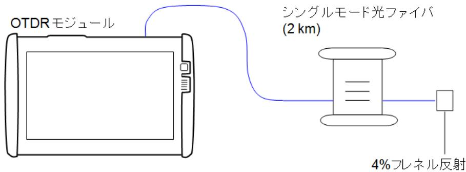
850 nm, 1300 nmの距離測定確度を試験する場合は、接続図の光ファイバをマルチモードファイバ(2 km)に変更してください。
