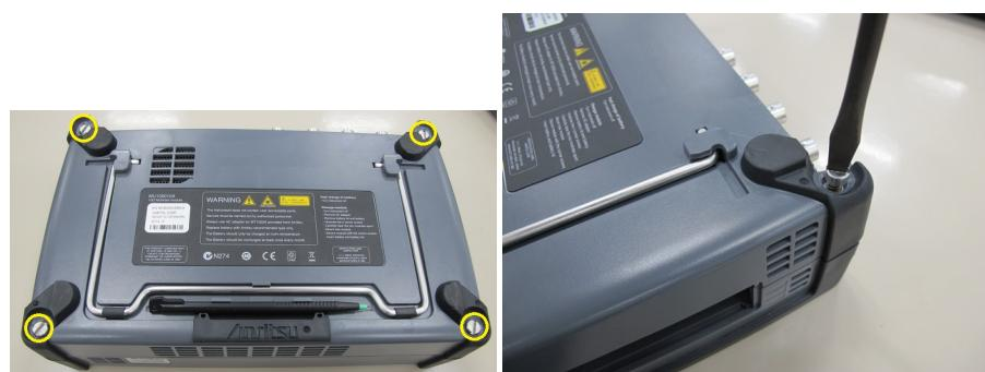
5. すべてのネジを緩めたら、10Gマルチレート モジュールの両側を持ち上げて取り外します。取り外せない場合は4隅のネジを再度緩めてください。取り外すと、以下のようになります。
