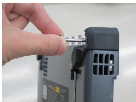
4. OTDRモジュールに10Gマルチレート モジュールを取り付けます。以下が組み合うように10Gマルチレート モジュールをOTDRモジュールの上に置きます。7 - 10, 8 - 11, 9 - 12
