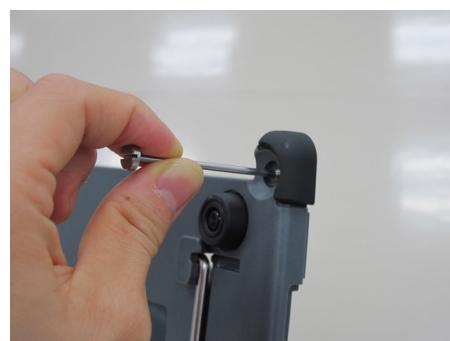
4. 背面パネルをOTDRモジュールに取り付けます。
