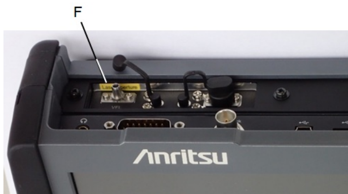
図8 ラベルの貼付位置 (オプション002付きの MU100020A, MU100021A, MU100022A, MU100023A)
