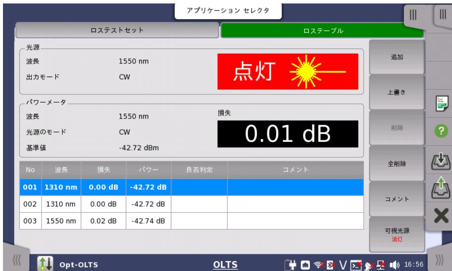
パワーメータの光源のモードに [Wave Code] と表示されている場合、パワーと損失が表示されます。
