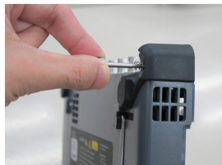
4. OTDRモジュールに10Gマルチレート モジュールを取り付けます。以下が組み合うように10Gマルチレート モジュールをOTDRモジュールの上に置きます。
