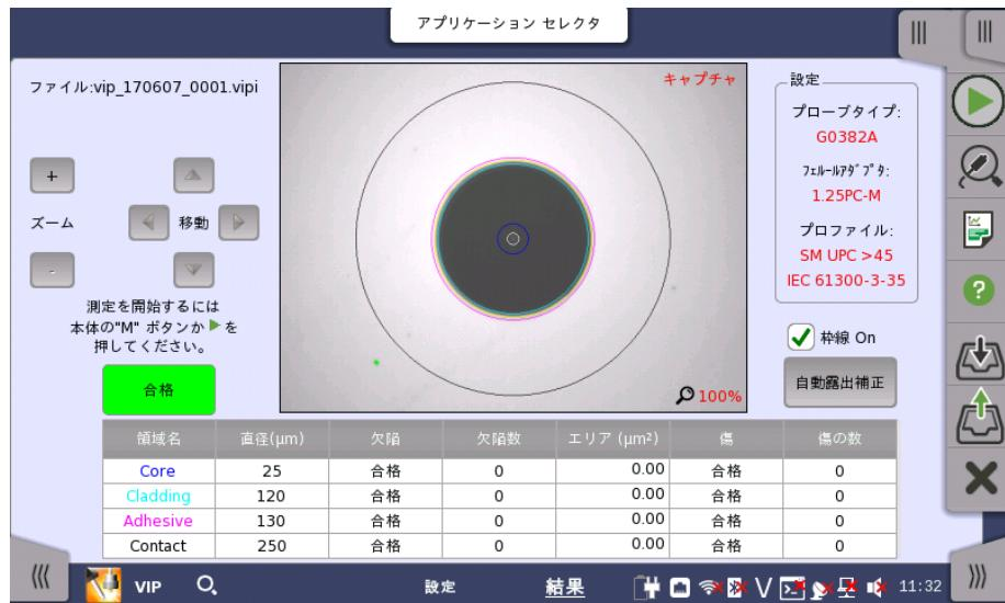
ファイバスコープで撮影した画像が表示されます。また、ファイバ端面の画像を解析できます。
