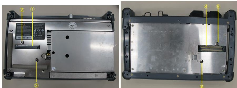
3. B0728A 背面パネルキットの1Uネジを背面パネルの四隅に挿入します。
