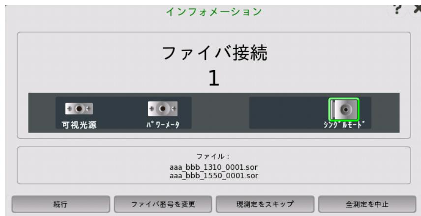
上の枠には、[ファイバ接続] の下にファイバの番号と、接続するOTDRモジュールのコネクタが表示されます。下の枠には保存されるファイル名が表示されます。
