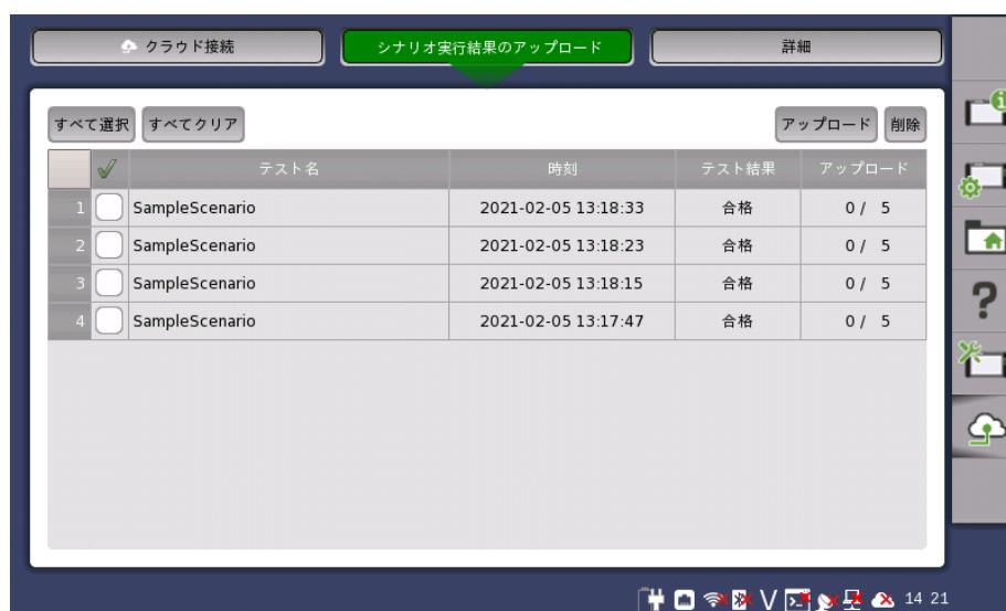
未アップロードの結果ファイルが存在するテストの実行結果がリストに表示されます。アップロード欄には、アップロード済ファイル数とアップロードする全ファイル数が表示されます。
