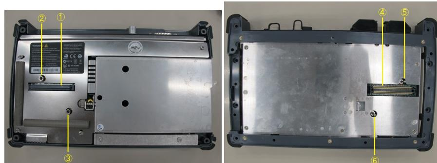
3. 10Gマルチレート モジュールの四隅のネジを抜き取り,B0728A 背面パネルキットの2Uネジに交換します。
