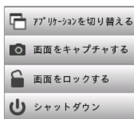
[シャットダウン] をタッチすると確認のダイアログボックスが表示されますので、[はい] をタッチしてシャットダウンします。
