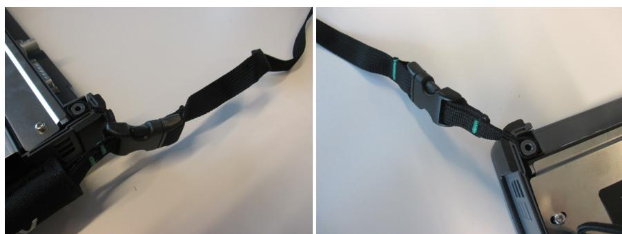
9. 1～3と逆の手順でネットワークマスターにMU100010Aを取り付け、バッテリーパックを挿入した後にバッテリのふたを取り付けます。
