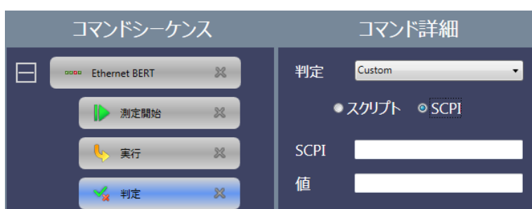
図 3.4.7.8-3 判定コマンドの詳細 (SCPI)
