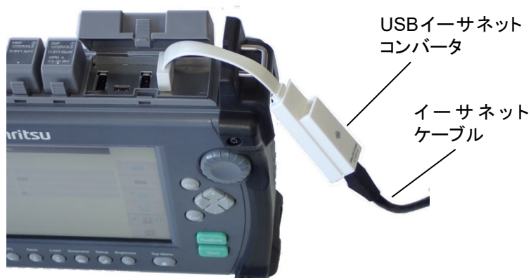
図 11.2.1-1 イーサネットケーブルの接続
