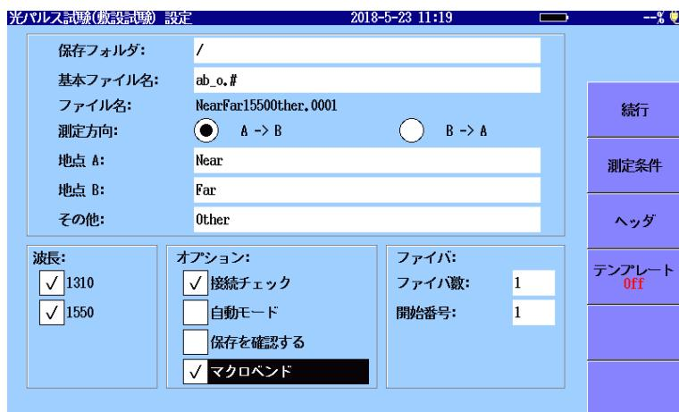
図 6.3-1 光パルス試験(敷設試験) 設定画面
