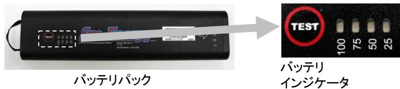
図 2.2.3-1 バッテリの残量
