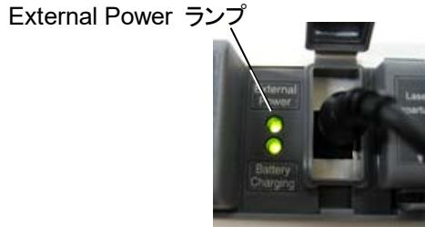
4. 充電したまま放置します。約 6 時間で充電が停止し, Battery Charging ランプが消灯します。なお, 約 5 時間で容量の 90%以上 の充電が終了します。
