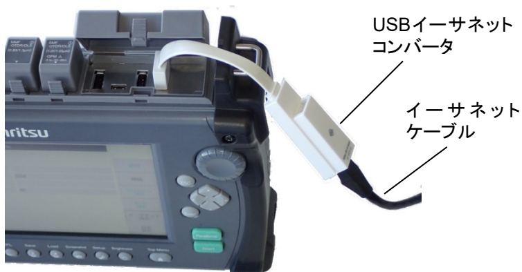
図 11.2.1-1 イーサネットケーブルの接続
