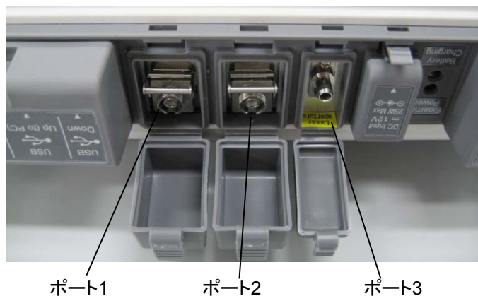
図 2.4-1 光ファイバの接続
