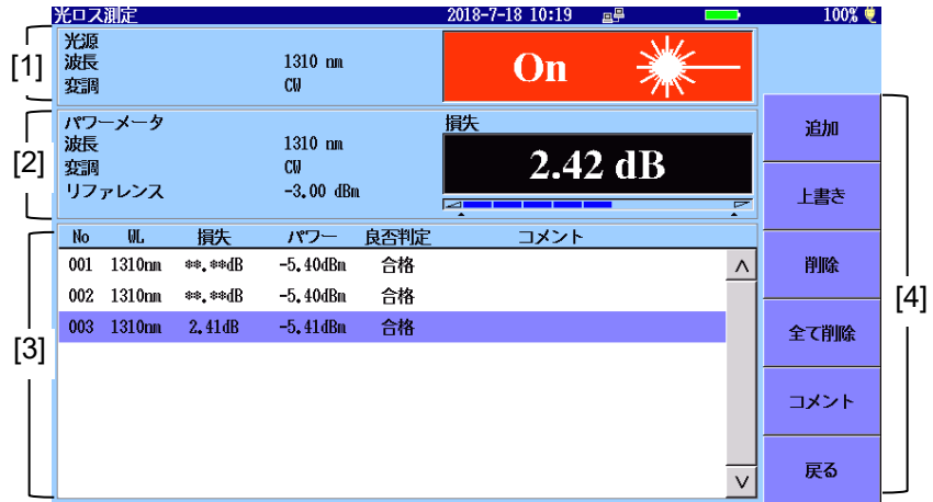
図 9.5-1 ロステーブル画面 (光ロス測定)
