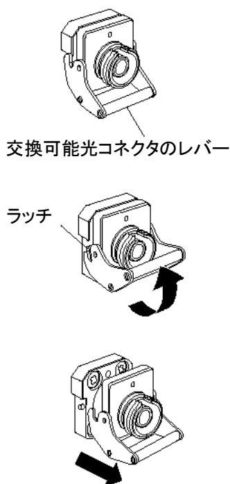
図 16.1-1 交換可能光コネクタの取り外し
