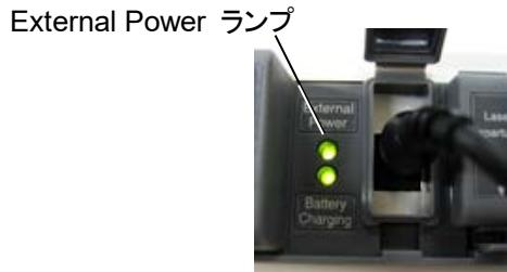
4. 充電したまま放置します。約 6 時間で充電が停止し, Battery Charging ランプが消灯します。なお, 約 5 時間で容量の 90%以上 の充電が終了します。
