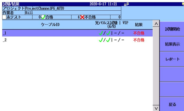
図 1.2.5-2 ケーブル認証試験の試験/結果画面
