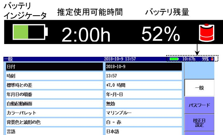
図 2.2.3-2 バッテリの残量確認
