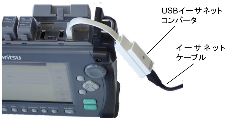
図 12.2.1-1 イーサネットケーブルの接続
