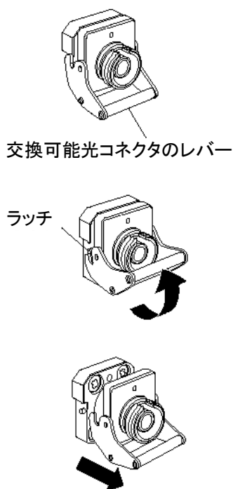
図 16.1-1 交換可能光コネクタの取り外し
