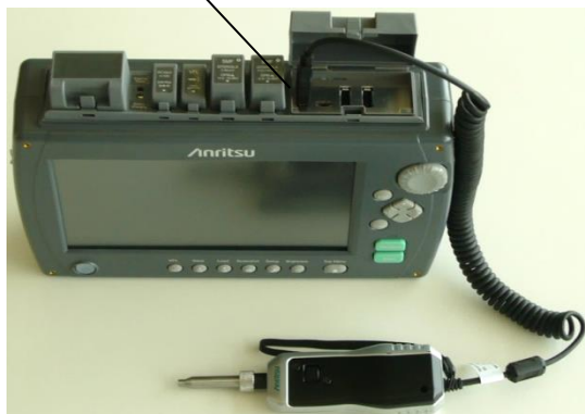
図 11.1-2 ファイバスコープの接続
