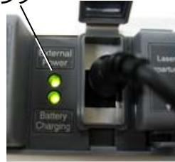
4. 充電したまま放置します。約 6 時間で充電が停止し、Battery Charging ランプが消灯します。なお、約 5 時間で容量の 90%以上 の充電が終了します。
