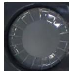
回転操作することにより  $\wedge$   $\vee$  または  $<$   $>$  と同じ操作ができます（操作は画面によって異なります）。押すことにより **Enter** と同じ操作ができます。
