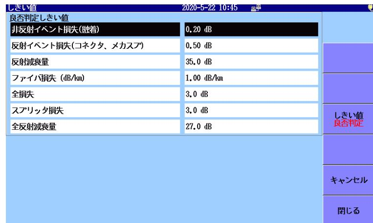
図 7.3.5.2-1 しきい値画面（良否判定、適用規格が【手動】のとき）
