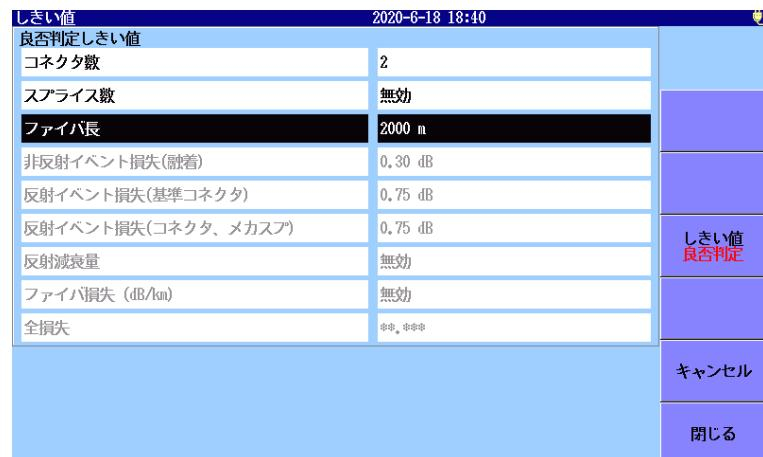
図 7.3.5.2-2 しきい値画面（良否判定、適用規格が【ISO/IEC 11801-3:2017】のとき）
