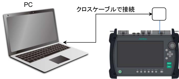
図 2.1.1-2 アクセスマスタと PC の直接接続例
