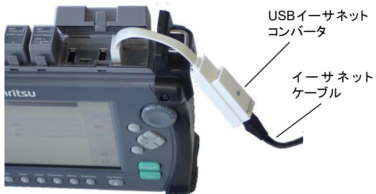
図 2.1.1-1 イーサネットケーブルの接続
