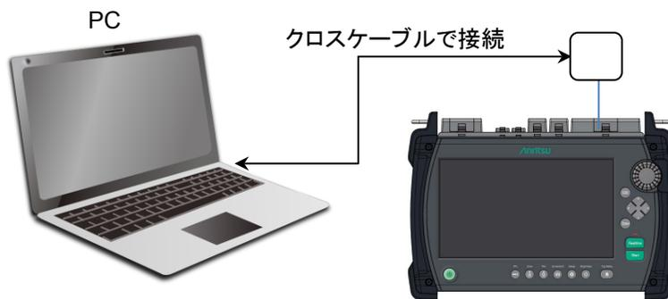
図 2.2.1-2 アクセスマスターと PC の直接接続例
