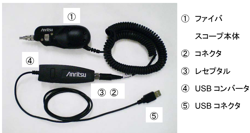
図 5.2.2-1 USB コンバータへの接続
