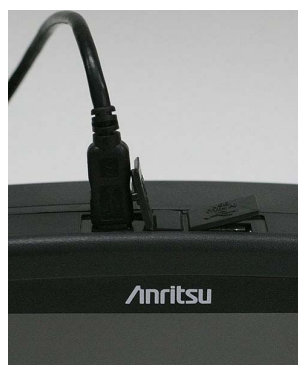
図 2.8.2-1 USB ケーブルの接続
