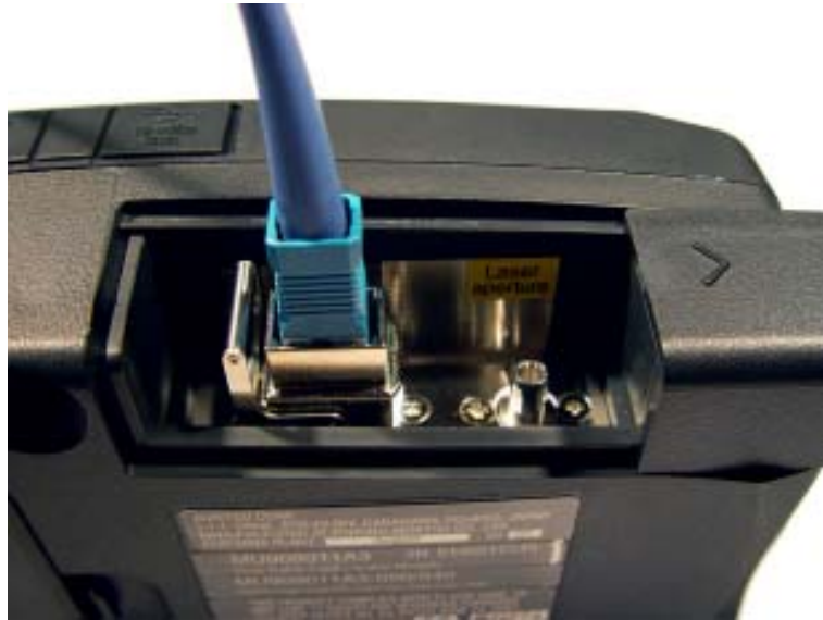
図 2.5-1 光ファイバケーブルの接続
