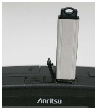
図 2.8.1-1 USB メモリの接続
