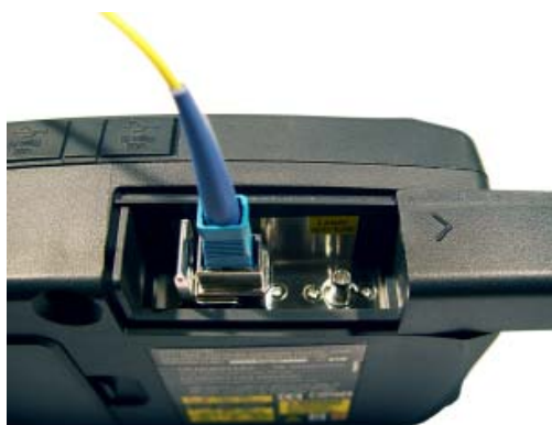
図 4.1.2-2 光ファイバケーブルの接続
