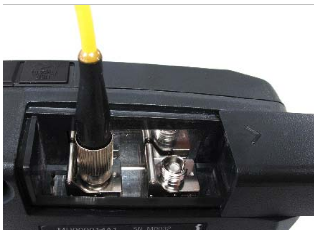
図2.6-1 光ファイバケーブルの接続
