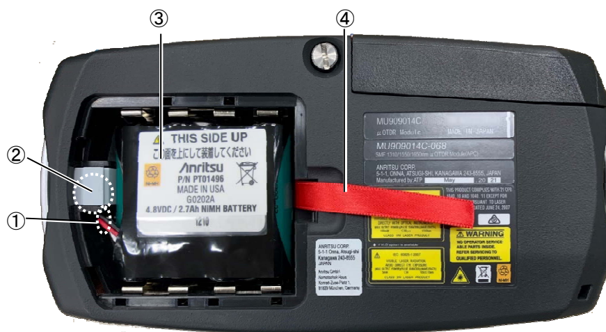
図2.5.1-1 バッテリー部
