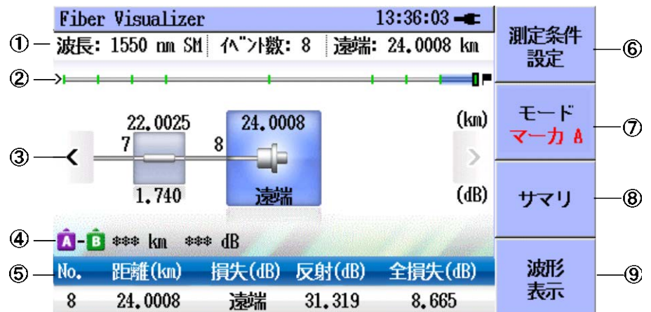
図4.12-2 Fiber Visualizer (イベント) 画面
