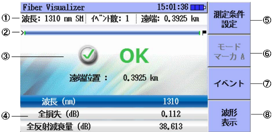
図4.12-1 Fiber Visualizer (サマリ) 画面
