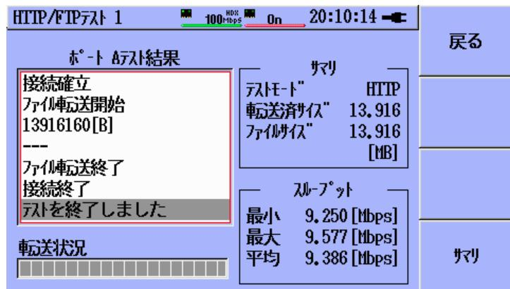
図 3.9.2-1 [HTTP/FTP ダウンロード] – HTTP テスト結果
