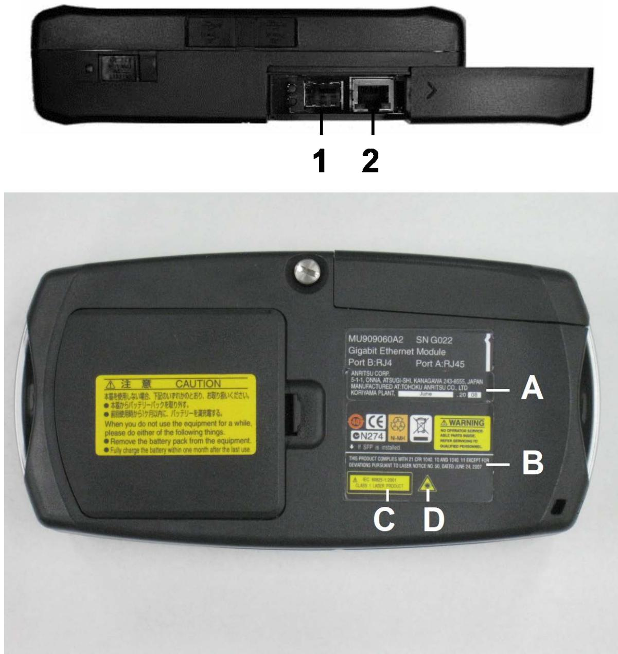
図1 レーザ光の開口位置, ラベルの貼付位置
