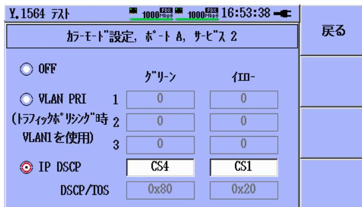
図3.11.6-39 サービス設定 – IP DSCP コードポイント選択
