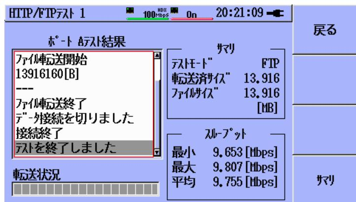
図 3.9.2-2 [HTTP/FTP ダウンロード] – FTP テスト結果
