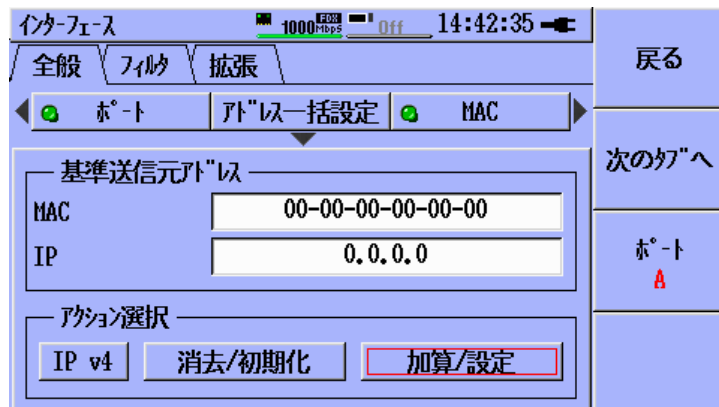
図3.12-8 インタフェース設定 - [アドレス一括設定]ボタン (加算/設定ボタンハイライト表示)
