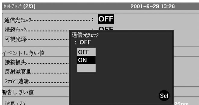
設定したい値にカーソルが移動したら、
