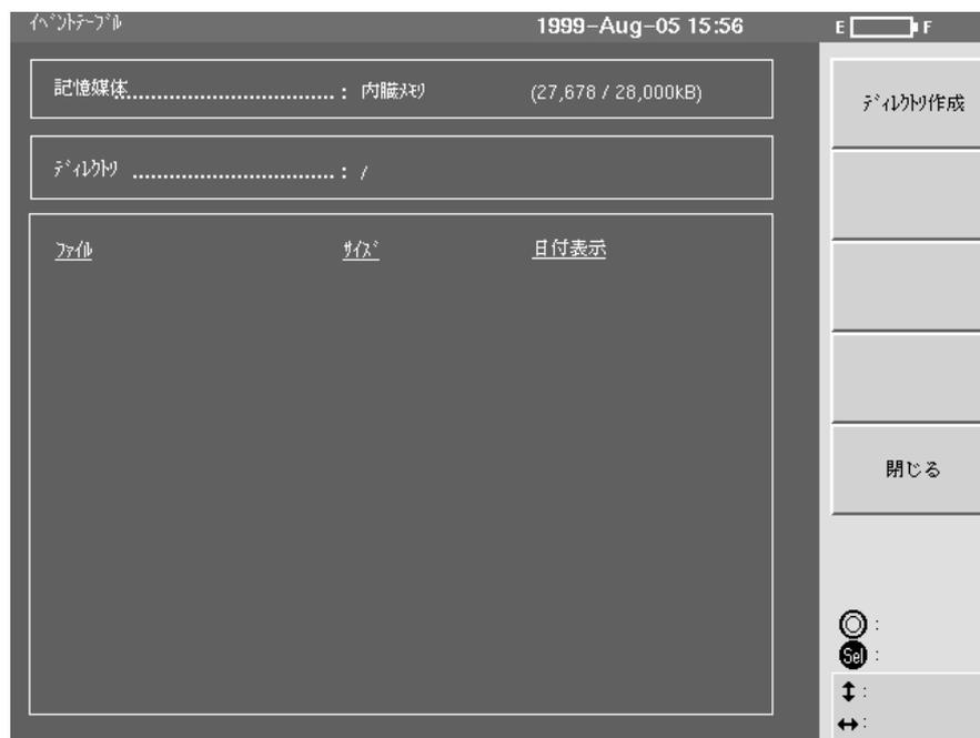
で保存したいディレクトリを選択して  または   を押すと、そのディレクトリに移行します。そのとき、ディレクトリの表示が選択されているディレクトリ名に変更されます。1つ上のディレクトリに戻るときは、カーソルを[..]に合わせてから  または   を押します。
