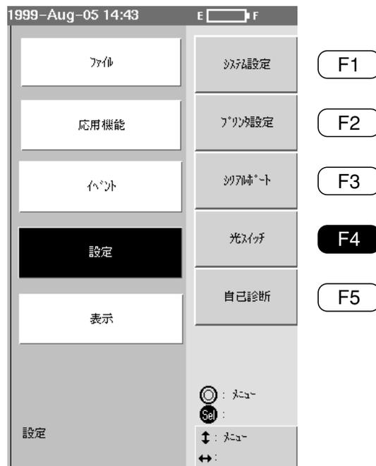
**F4** (光スイッチ) を押すと光チャンネルセレクタ設定画面になります。(下図)
