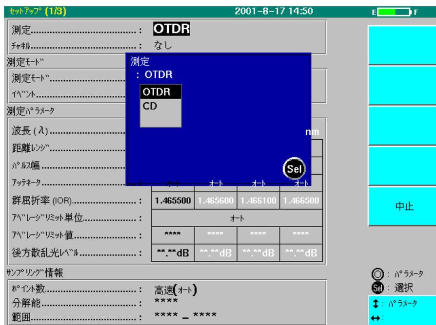
CDを選択すると、波長分散(CD)測定へ移行し、次ページのような画面が表示されます。
