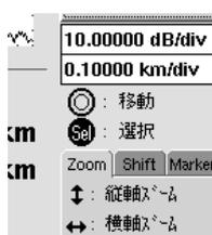
このとき **△** と **▽** は縦軸方向の拡大・縮小に、**<** と **>** は水平方向の拡大・縮小に使用します。
