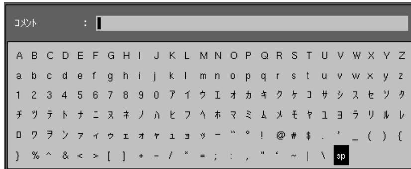
**<** **>** で入力したい位置にカーソルを移動します。ロータリノブで、入力したい文字を選択します。入力が完了したら **F5** (入力終了)を押します。入力されたコメントが確定され、画面上の"コメント"の横に表示されます。
