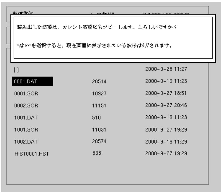
選択した波形と同じ測定条件で測定を実施したい場合は、**F1** (はい) を押してください。この場合は、選択したファイルを基準波形としてMW9076に読み出すとともに、同じファイルがカレント波形としてMW9076に読み出されます。
