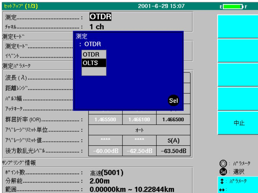
OLTSを選択して、**Select**を押すとOLTS測定へ移行します。移行すると、次ページの画面が表示されます。
