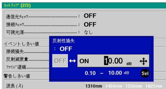
**<** **>** を押して、変更したい桁に合わせ **^** **v** で数値を変更します。 **<** を押し続けると、OFFになります。
