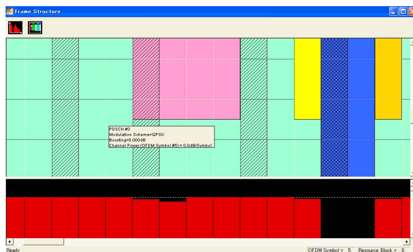
図 3.1.7.1-1 Frame Structure 拡大表示
