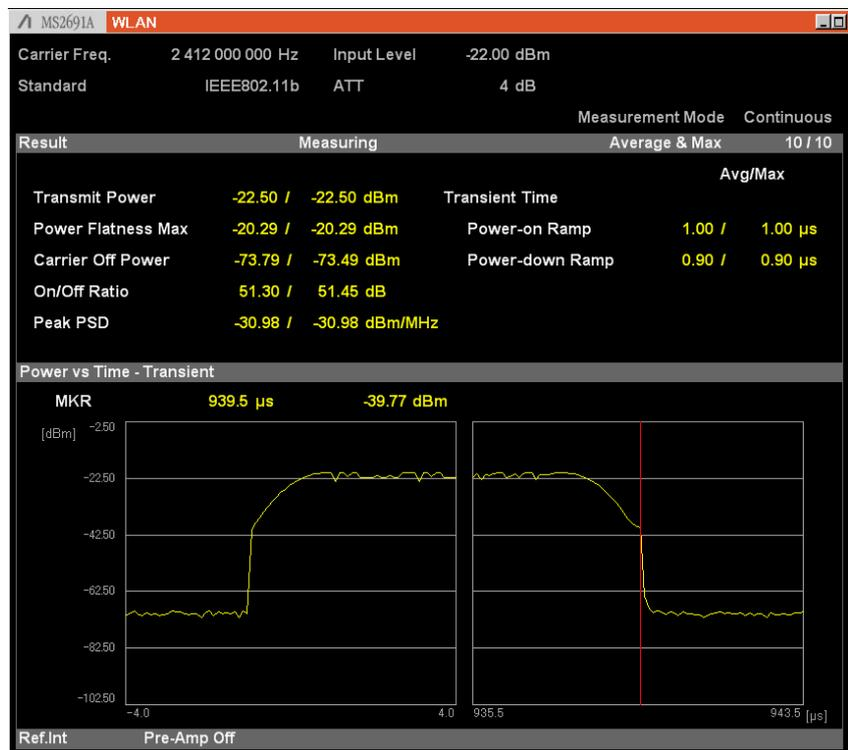
図3.18-1 Power vs Time 設定画面 (Transient)
