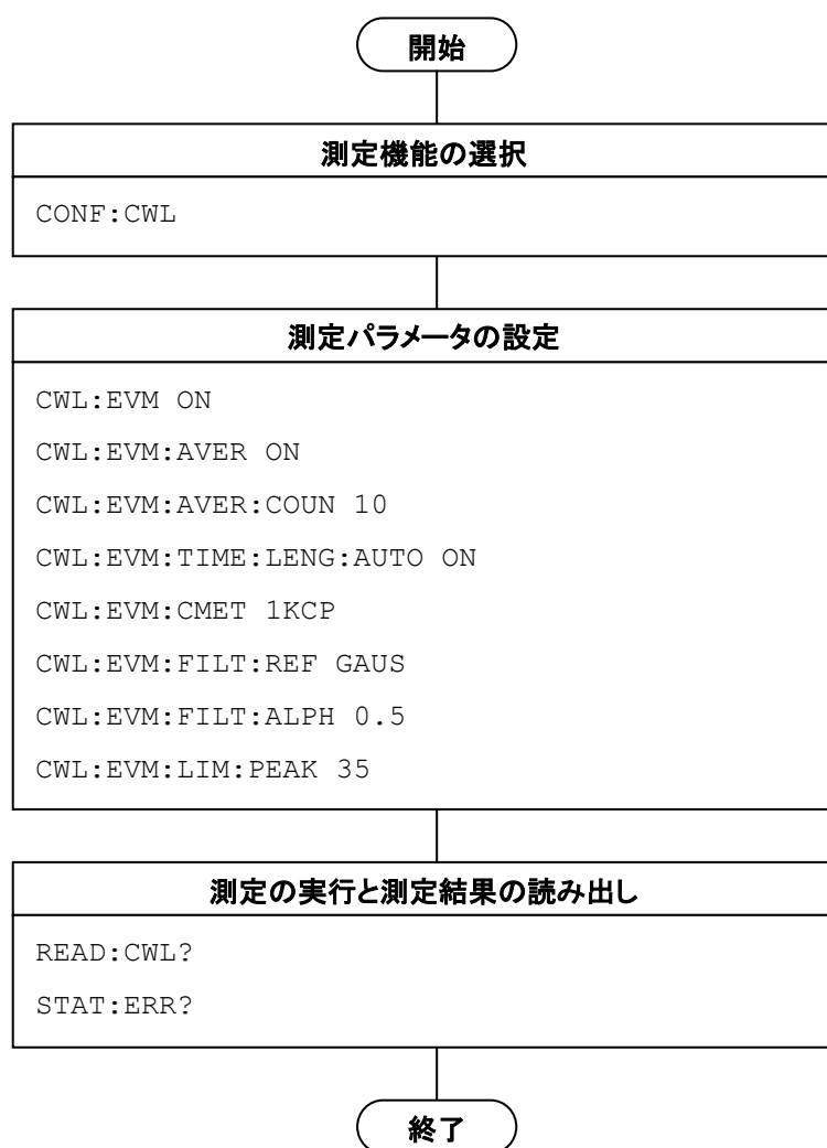
図 1.2.4-1 Modulation 測定の流れとコマンド例
