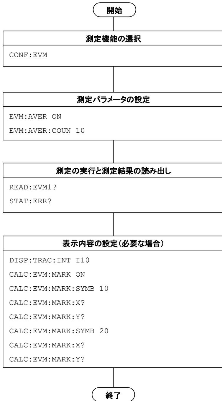
図 1.2.4-1 Modulation 測定の流れとコマンド例
