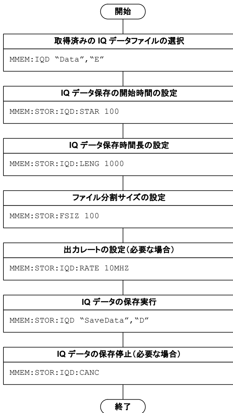
図 1.2.6-1 IQ データの保存の流れとコマンド例
