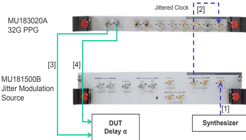
図B.1-1 Jitter-PPG 接続例
