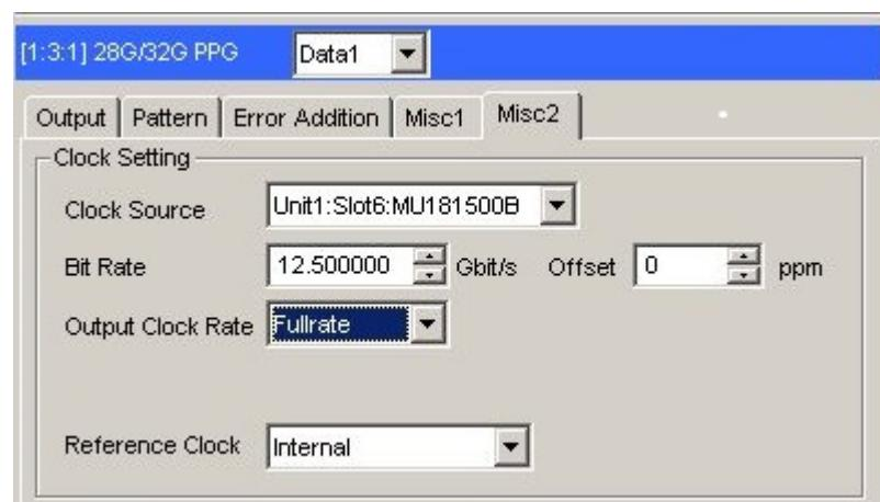
図B.3-2 MU183020A Misc2Output Clock Rate 設定
