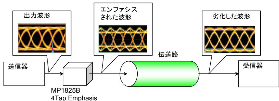
図1.1-2 本器による波形補正
