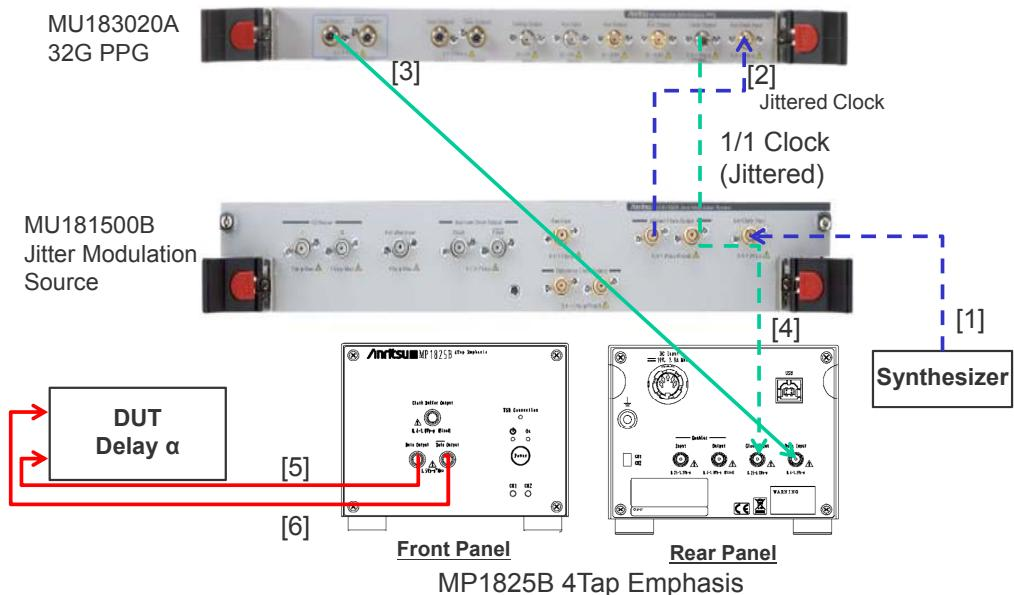
図B.3-1 Jitter-PPG-Emphasis 接続例
