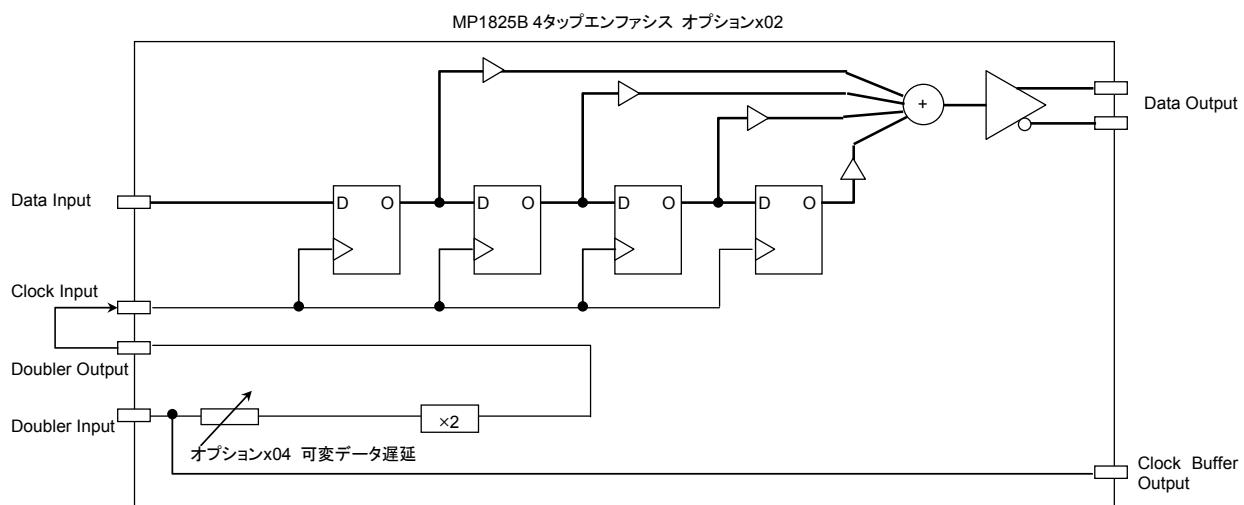
図2.2.3-2 MP1825B-x02 28Gbit/s Operation ブロック図
