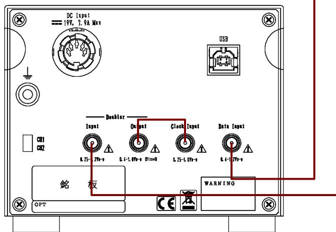
図3.3-5 MU182020A 25Gbit/s 1ch MUXとの接続 (ビットレート 8~28 Gbit/s)
