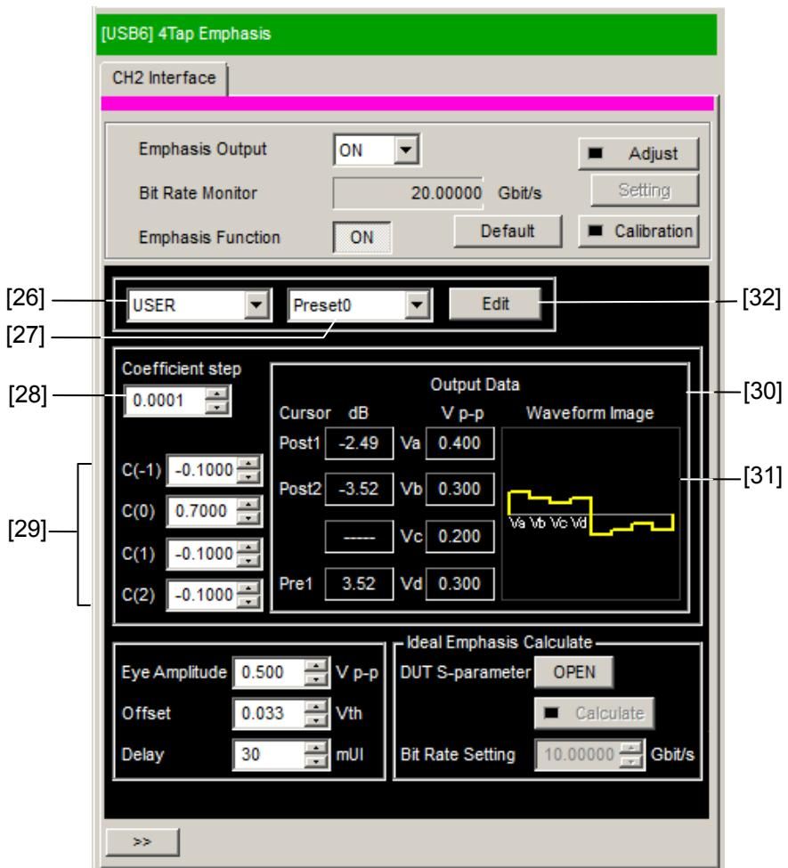
図3.1.3-5 MP1825B 制御画面 (半画面, Coefficient 設定)
