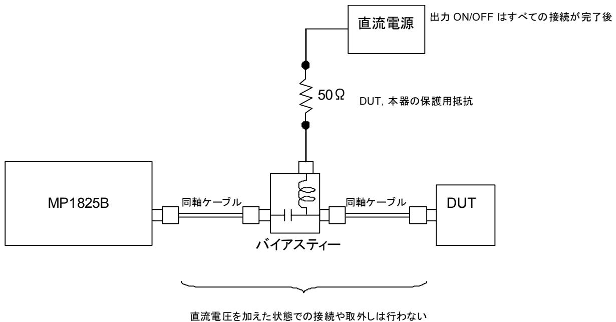
図2.8-1 バイアステーの接続例
