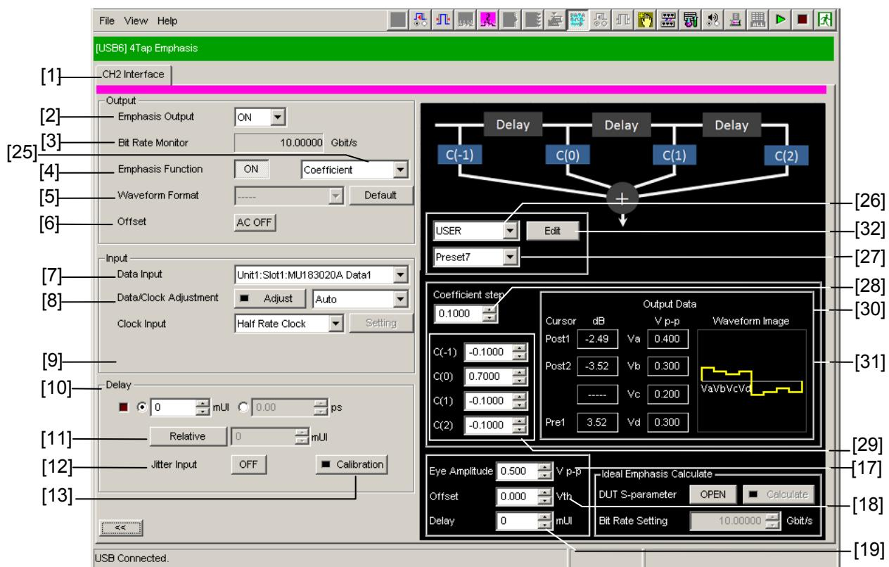
図3.1.3-2 MP1825B 制御画面 (全画面, Coefficient 設定)
