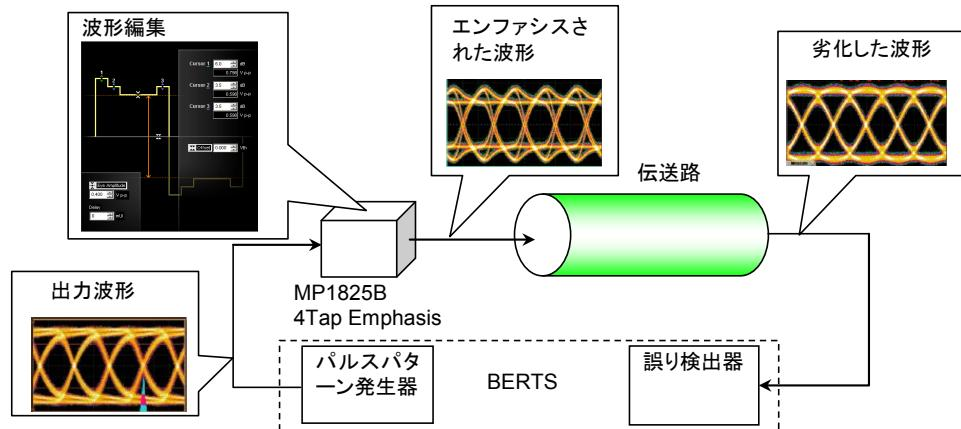
図1.1-3 エンファシスされた波形の評価方法
