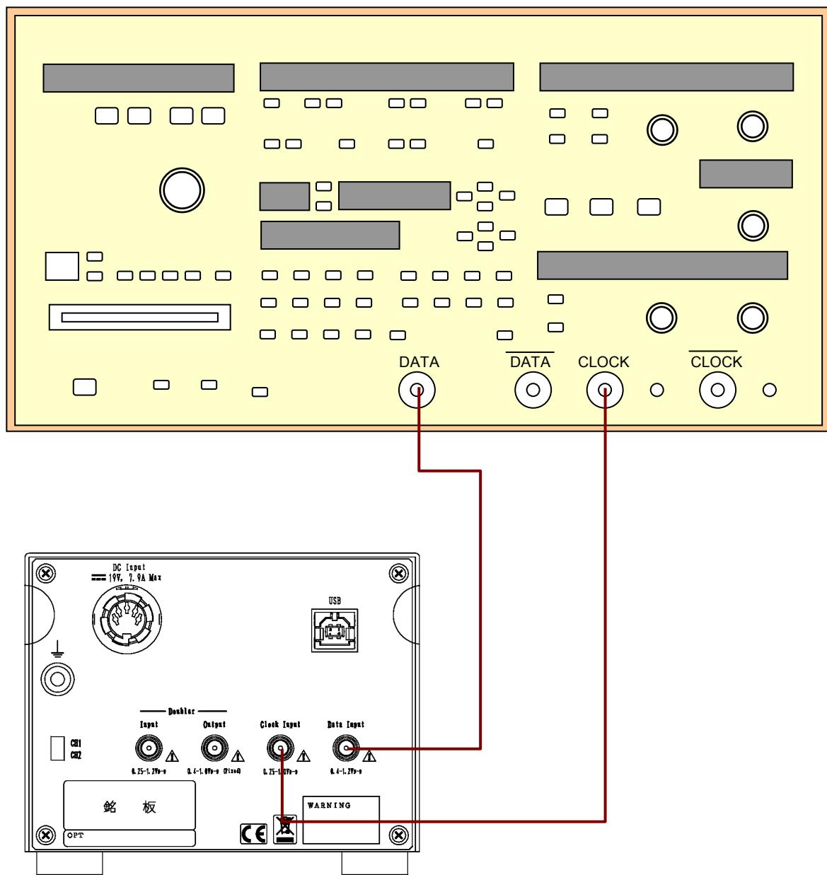
図3.3-3 パルスパターン発生器との接続 (ビットレート 1~28 Gbit/s)
