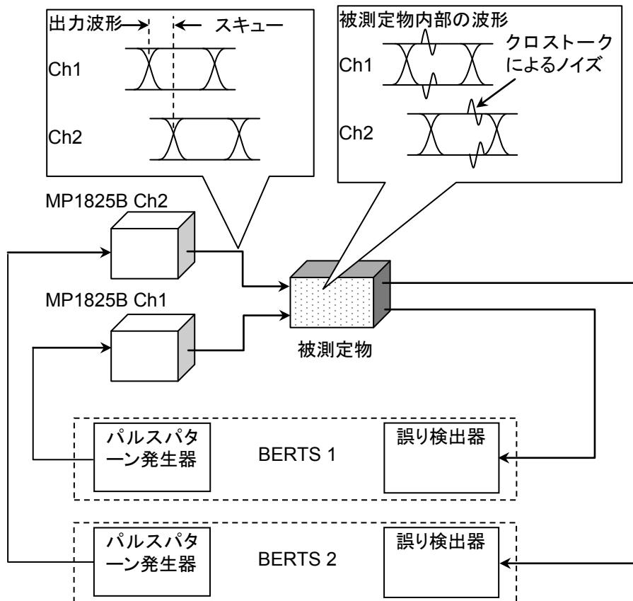
図1.1-4 クロストーク耐力の評価方法
