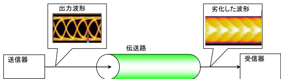
図1.1-1 伝送路による波形の劣化
