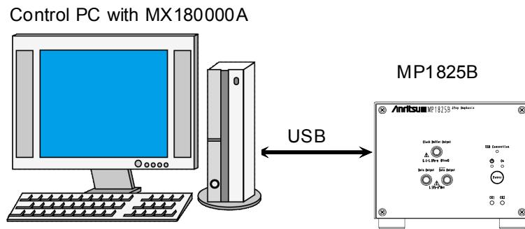
図2.5.2-3 制御用コンピュータとの接続方法
