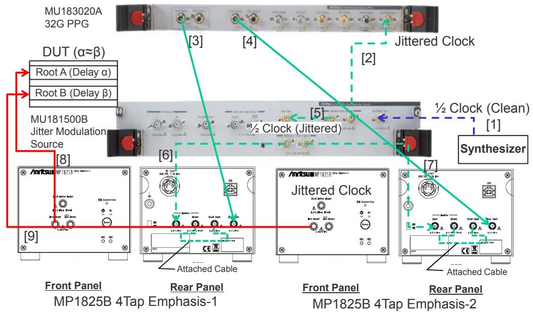
図B.5-1 Jitter-2ch PPG-Emphasis2 台接続例
