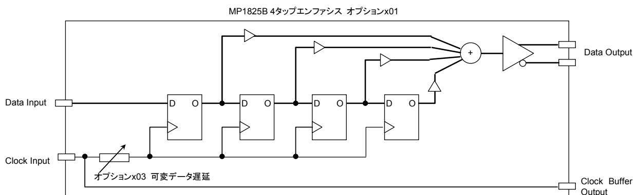
図2.2.3-1 MP1825B-x01 14Gbit/s Operation ブロック図
