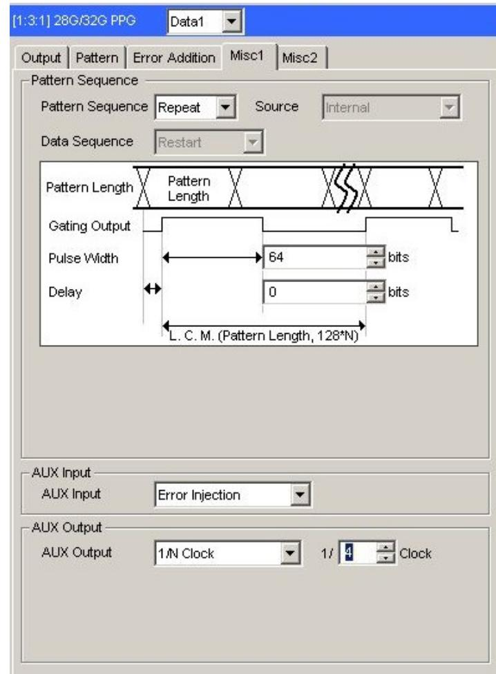
図B.4-2 MU183020A Misc1 AUX Output 設定
