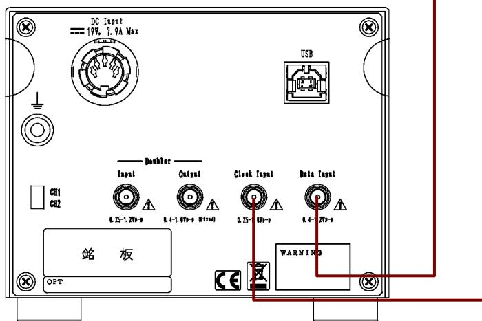
図3.3-4 MU181020A/B パルスパターン発生器との接続 (ビットレート 1~14 Gbit/s)
