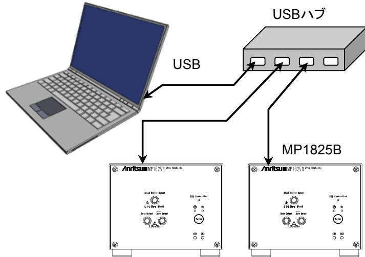
図2.5.2-5 USBハブを使用した制御用コンピュータとの接続方法
