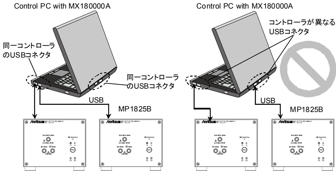
図2.5.2-4 制御用コンピュータとMP1825B 2台の接続方法
