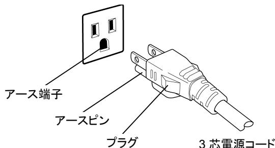
図2.4-1 電源コードの接続図
