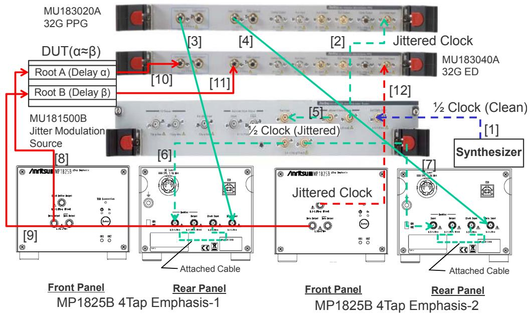
図B.6-1 Jitter-2ch PPG-Emphasis2台-ED 接続例
