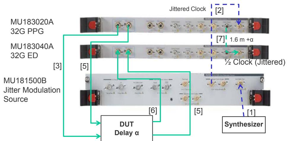
図B.2-1 Jitter-PPG-ED 接続例
