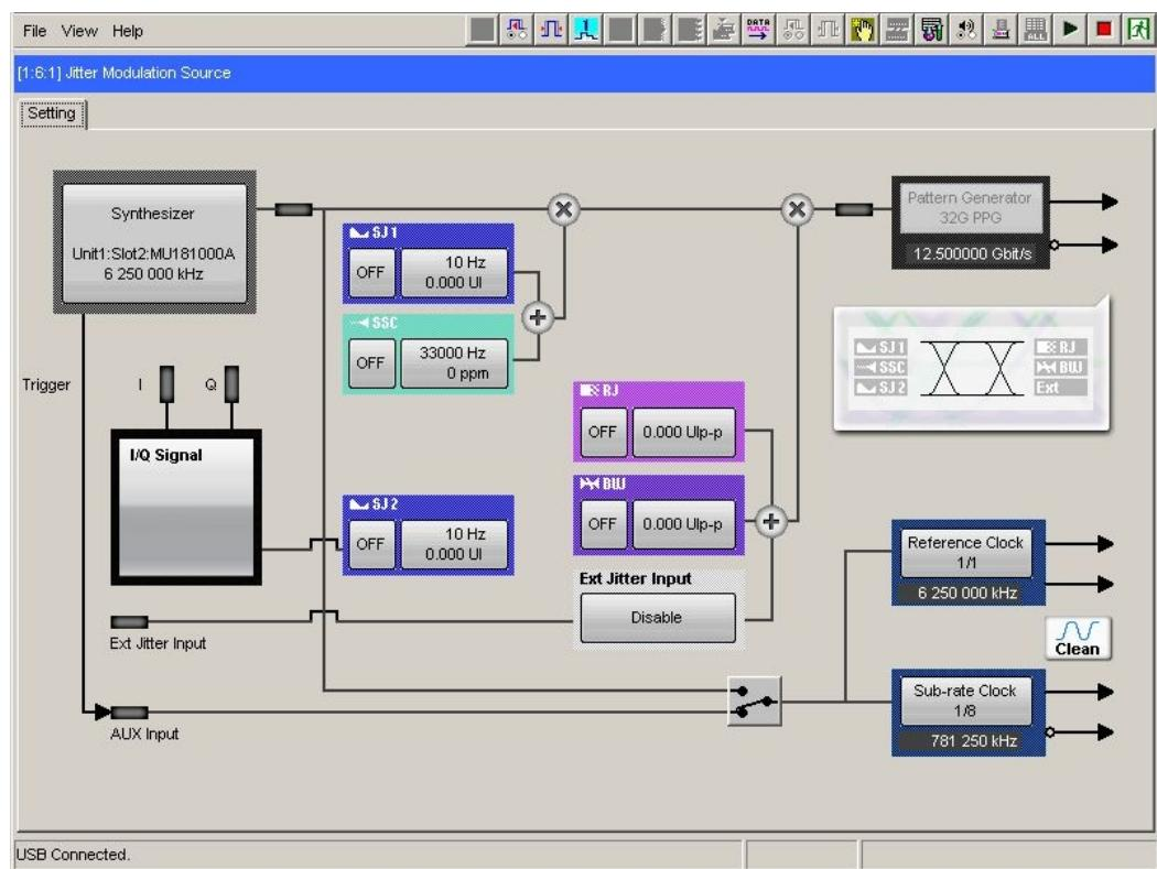
図B.5-3 MU181500B AUX, Reference Clock 設定
