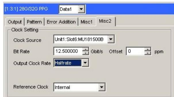
図B.5-2 MU183020A Misc2 Output Clock Rate 設定
