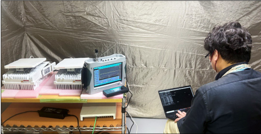
江東区の品質管理センターに設置されたCelona検証ラボ。電波シールドテント内で「MS2090A」による無線品質評価を実施した。
