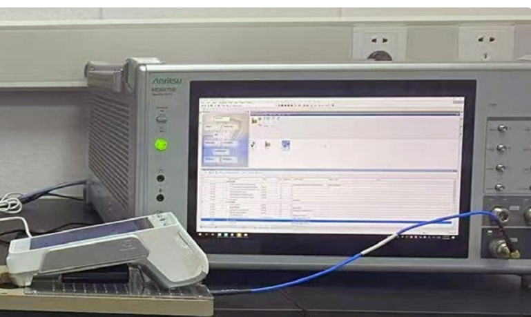
図1：アンリツのシグナリングテスト（基地局シミュレータ） MD8475B（PAX Technology様にて）
