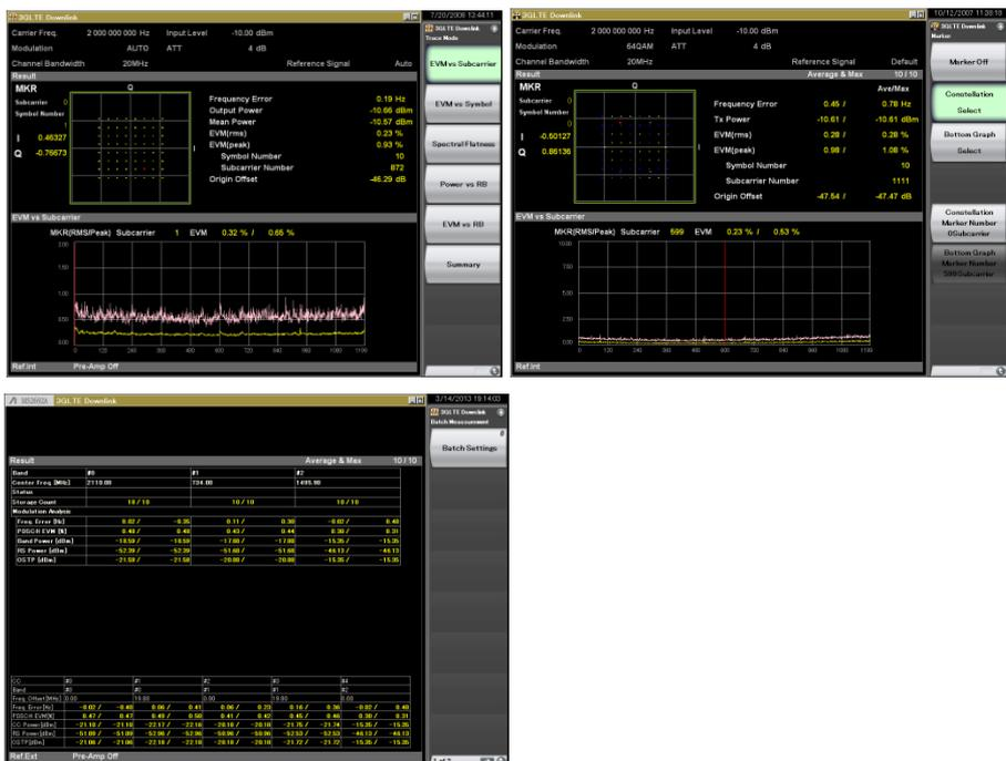
MX269020A/MX269021A は、3GPP LTE (Long Term Evolution) で規定されるダウンリンク(FDD) およびアップリンク(FDD)信号のRF送信特性を測定するためのソフトウェアです。
