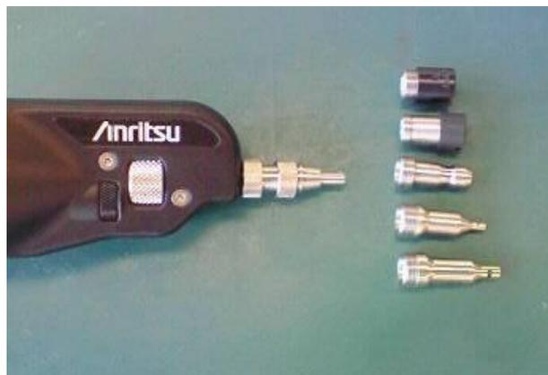
ファイバ스코ープの先端には、接続するコネクタ(アダプタ)形状に合ったチップを接続します。
