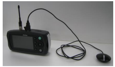
外部GPSを取り付けた使用例
