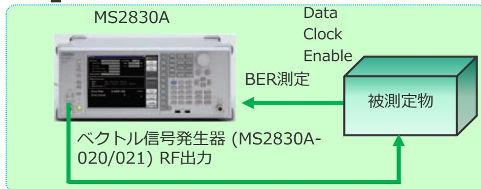
BER測定セットアップ例(MS2830A-020/021搭載時)
