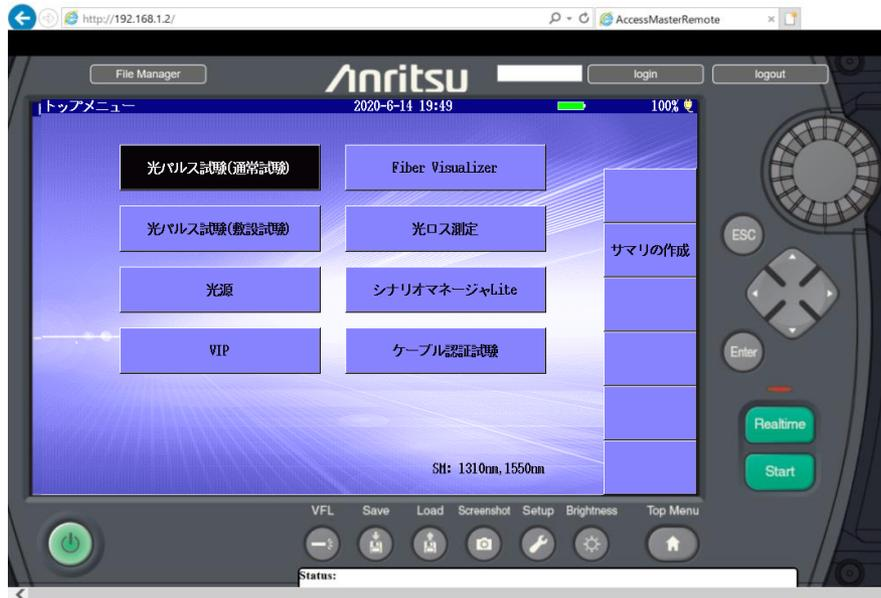
リモートGUI機能を使用したPCからの外部制御画面
