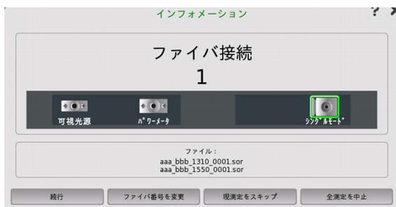
7. 光ファイバのコネクタをクリーニングして、ネットワークマスタの測定ポートに接続します。
