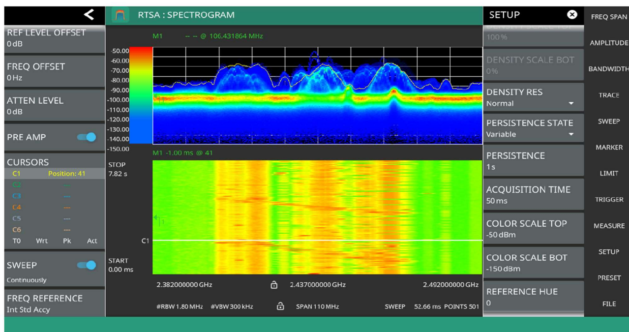
図 20. 一画面に密度表示とスペクトログラムを表示。2.4 GHz ISM バンドでの信号の様子
