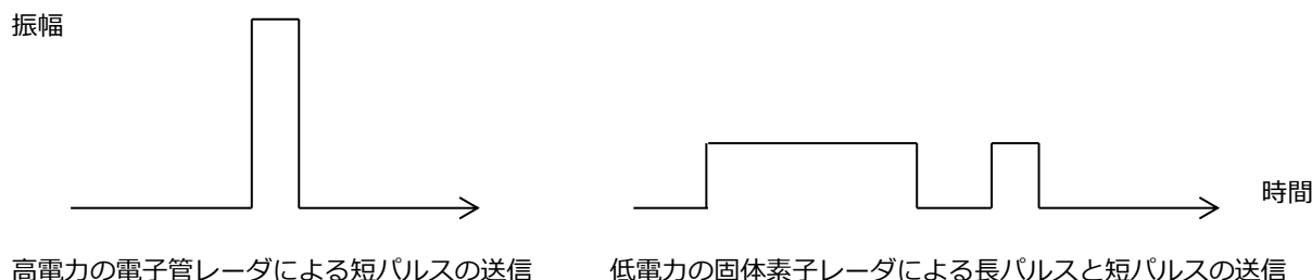
図 2-3 パルスレーダの概念図
