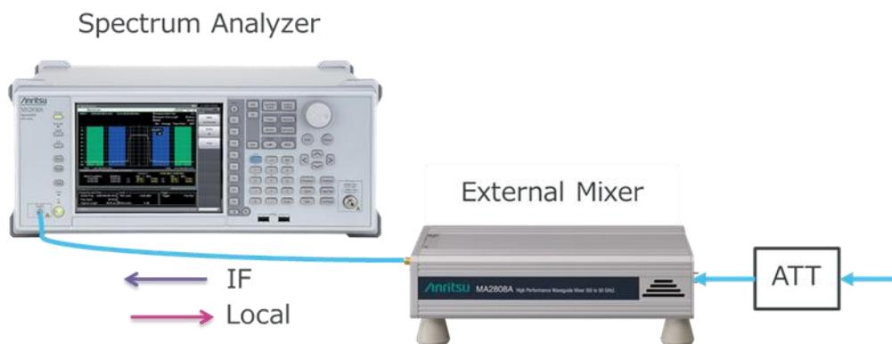
図 5-5 外部ミキサとスペクトラムアナライザによるマイクロ/ミリ波の測定
