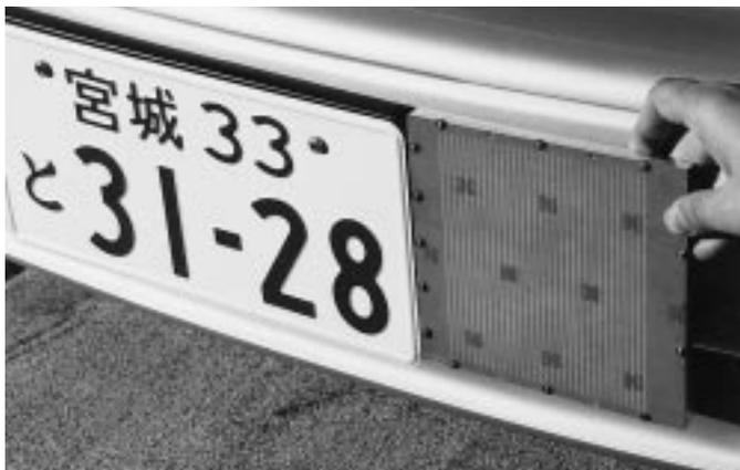
3 dBカップラーをショートすると、完全にこう電波が透過するんですね。この中にレーダーを組み込んで、ある種のLeaky NRDガイドというアンテナで、Slot Arrayから電波を出す。カップラーを通して100%エネルギーが移動して、Slotから放射するというわけです。厚さ1センチと言ったんですが、1センチの中はどのように別れていまして、上がアンテナ、下がレーダーの回路が入っているということです。
