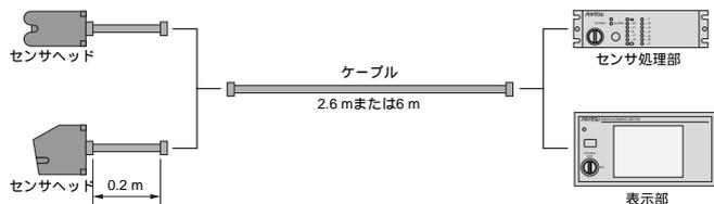
図2 高性能光マイクロの構成
