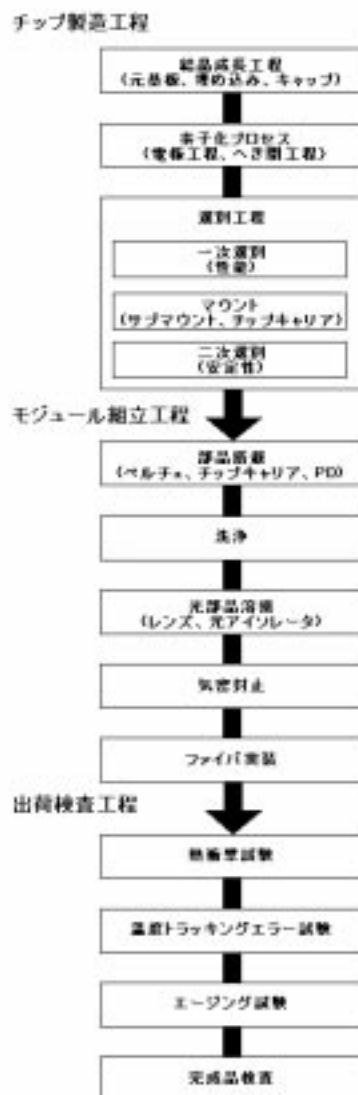
図1 LDモジュール製造工程フロー LD module manufacturing procedure
