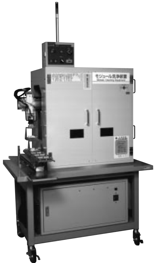
図4 モジュール自動洗浄機の外観 External view of automatic module cleaning equipment
